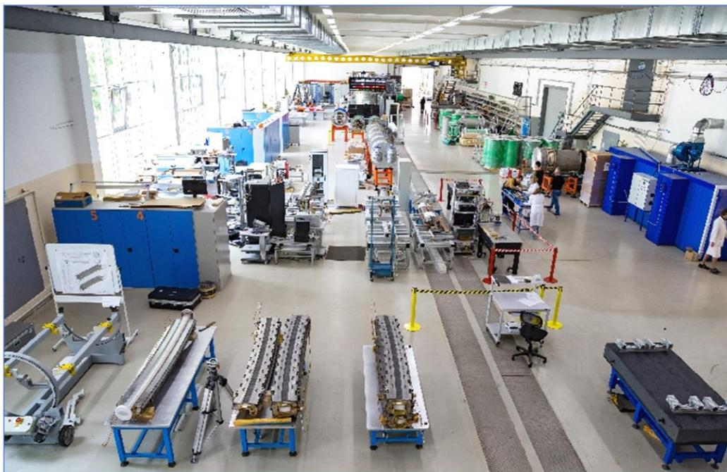
**Рис. 4.** Стенд изготовления и испытаний сверхпроводящих магнитов
