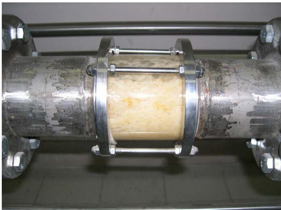
Рисунок 9. Структура горизонтального потока смеси эксоло и воздуха при давлении 5 бар, расход эксоло составляет 9.35 кг/с, а газовое объемное содержание 41.36 %.
