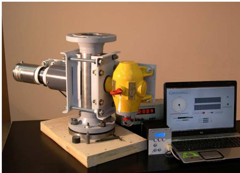
Рисунок 11. Гамма плотномер, установленный на стальную трубу. На рисунке показаны БГИ-45А с радиоактивным источником  $^{137}\text{Cs}$  17 мКи (желтый), сцинтилляционный детектор с кристаллом NaI (LB-4441-01-0a-Gd-E) и процессорный блок (LB-444) соединенный с ноутбуком.
