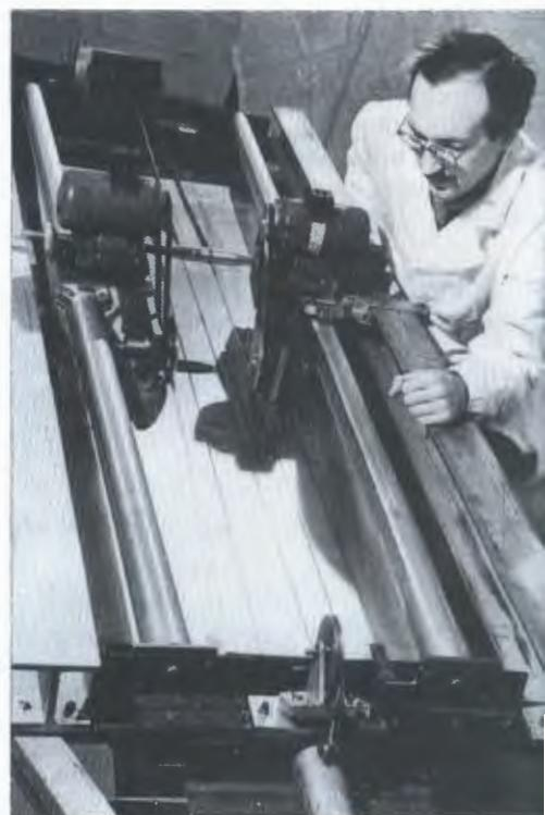
Лаборатория сверхвысоких энергий. Устройство для изготовления электродов пропорциональных камер с индуцированным съемом информации
