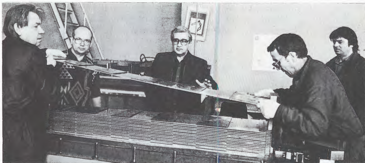
Лаборатория ядерных проблем. Заключительный этап сборки первого субмодуля адронного калориметра установки ATLAS
