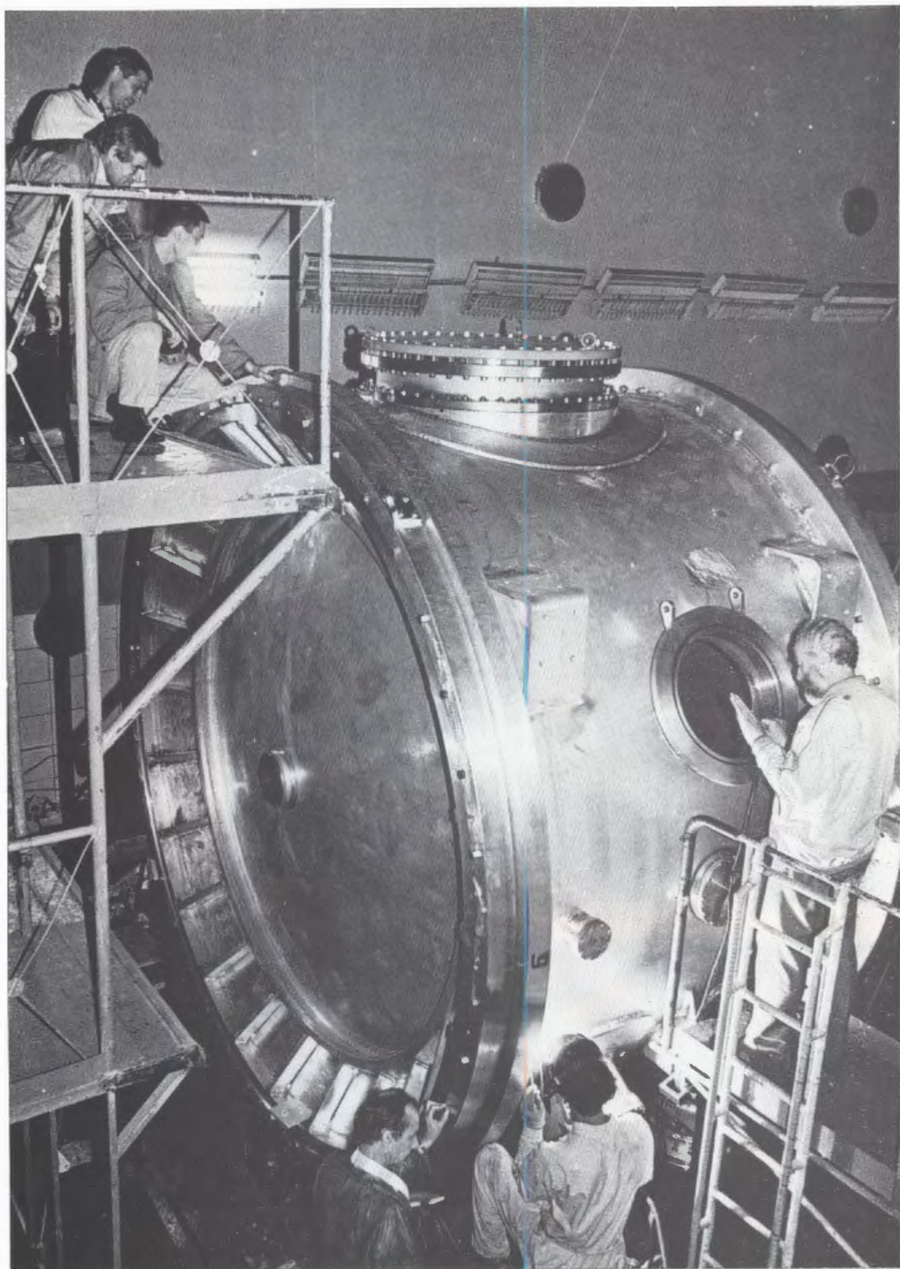
Лаборатория сверхвысоких энергий. Большой жидкокриптоновый калориметр, изготовленный в Государственном космическом научно-производственном центре им. Хруничева для совместного ОИЯИ — ЦЕРН эксперимента NA-48
