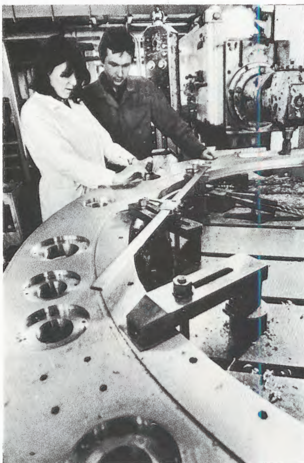
Опытное производство ОИЯИ. Изготовление узлов циклотрона для ускорительного комплекса «Тесла» в Белграде (Югославия)
