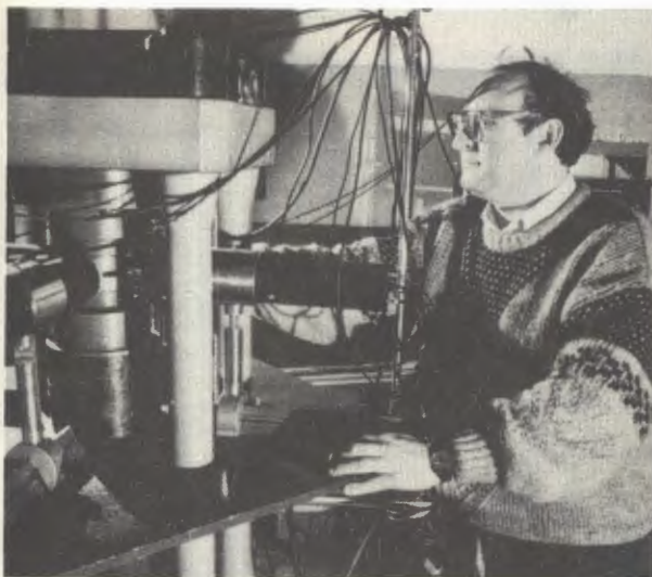
Установка для измерений дифференциальных возмущений угловых \gamma\gamma -корреляций
