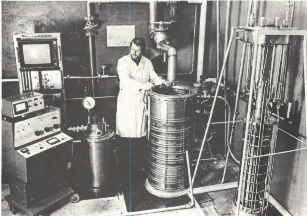
виями работы СПП У-70 исследовался макет системы коммутации в ИФВЭ на макете ВЧ-генератора. В результате сделан вывод, что наиболее приемлемым является вариант построения системы ВЧ-питания СПП без системы коммутации.
