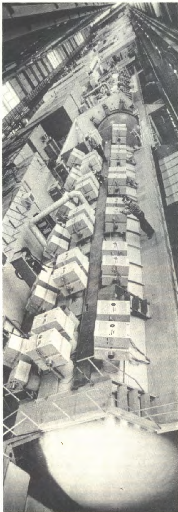
В ИФВЭ осуществлен пуск первой очереди комплекса "Меченые нейтрино". На снимке: жидкоаргонный калориметр комплекса
