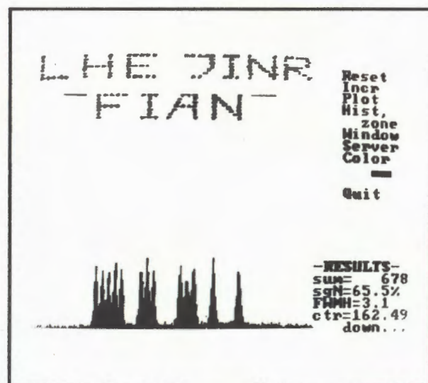
Созданный в ЛВЭ двумерный детектор медленных нейтронов. Слева – общий вид детектора. Вверху – снимок с дисплея, характеризующий пространственные разрешения прибора: точки, с помощью которых изображены буквы, соответствуют отверстиям диаметром 2 мм, выполненным в кадмиевой пластине
