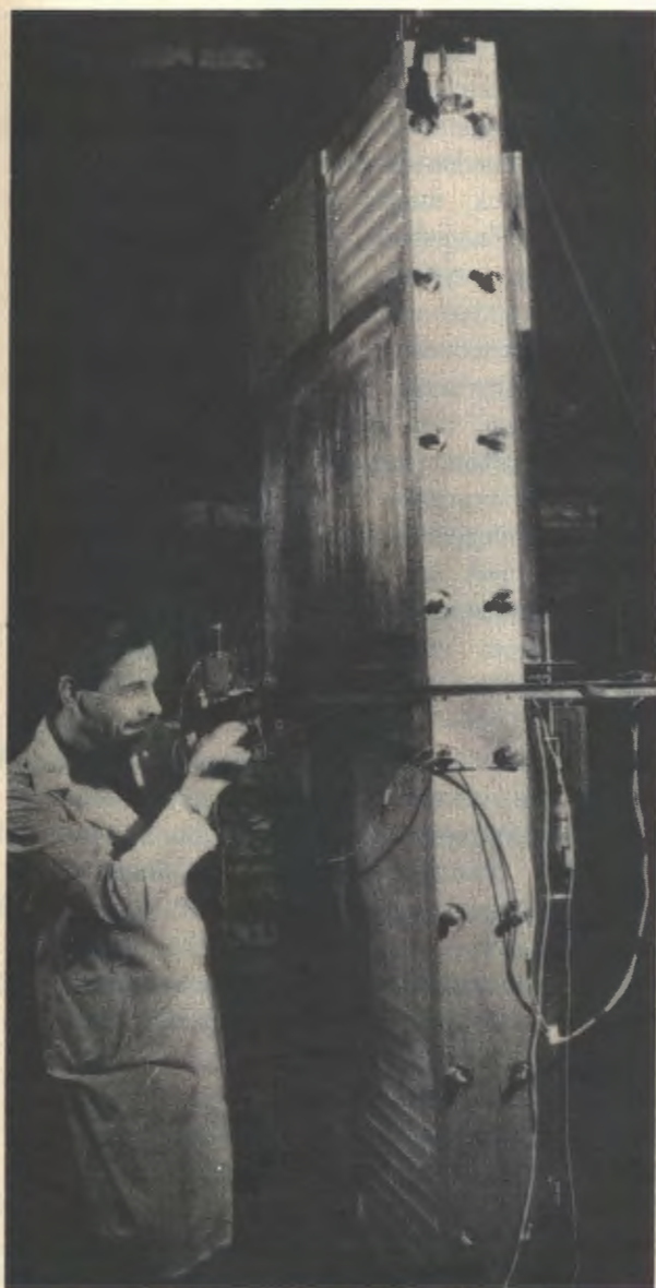
Полномасштабный \Delta -генератор прототипа дейтронного циклотрона ДЦ-1
