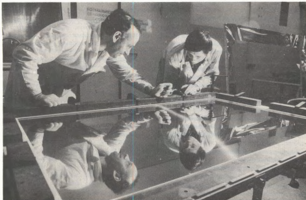
По технологии, разработанной в ОНМУ, в Опытном производстве ОИЯИ ведется изготовление серии больших пропорциональных камер для новой установки ОИЯИ — спектрометра с вершинным детектором, предназначенной для экспериментов на ускорителе ИФВЭ.
