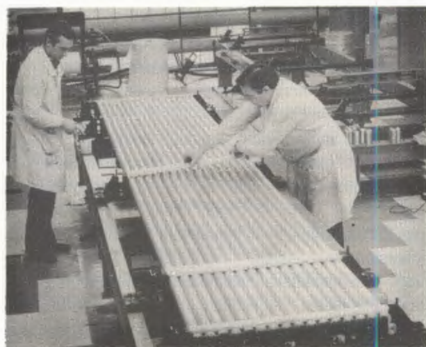
Изготовление модулей координатных плоскостей из дрейфовых трубок для установки "Меченые нейтрино".
