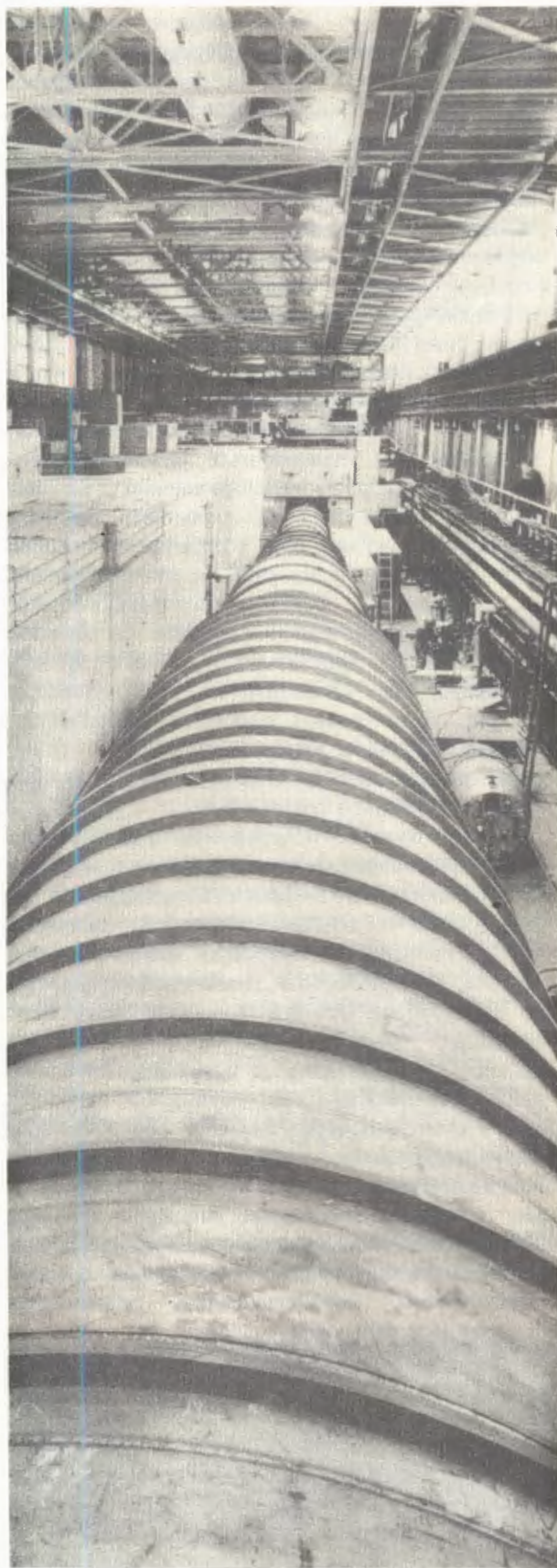
В экспериментальном зале ИФВЭ (Протвино) идут работы по созданию установки "Меченые нейтрино". На снимке: распадный канал установки.
