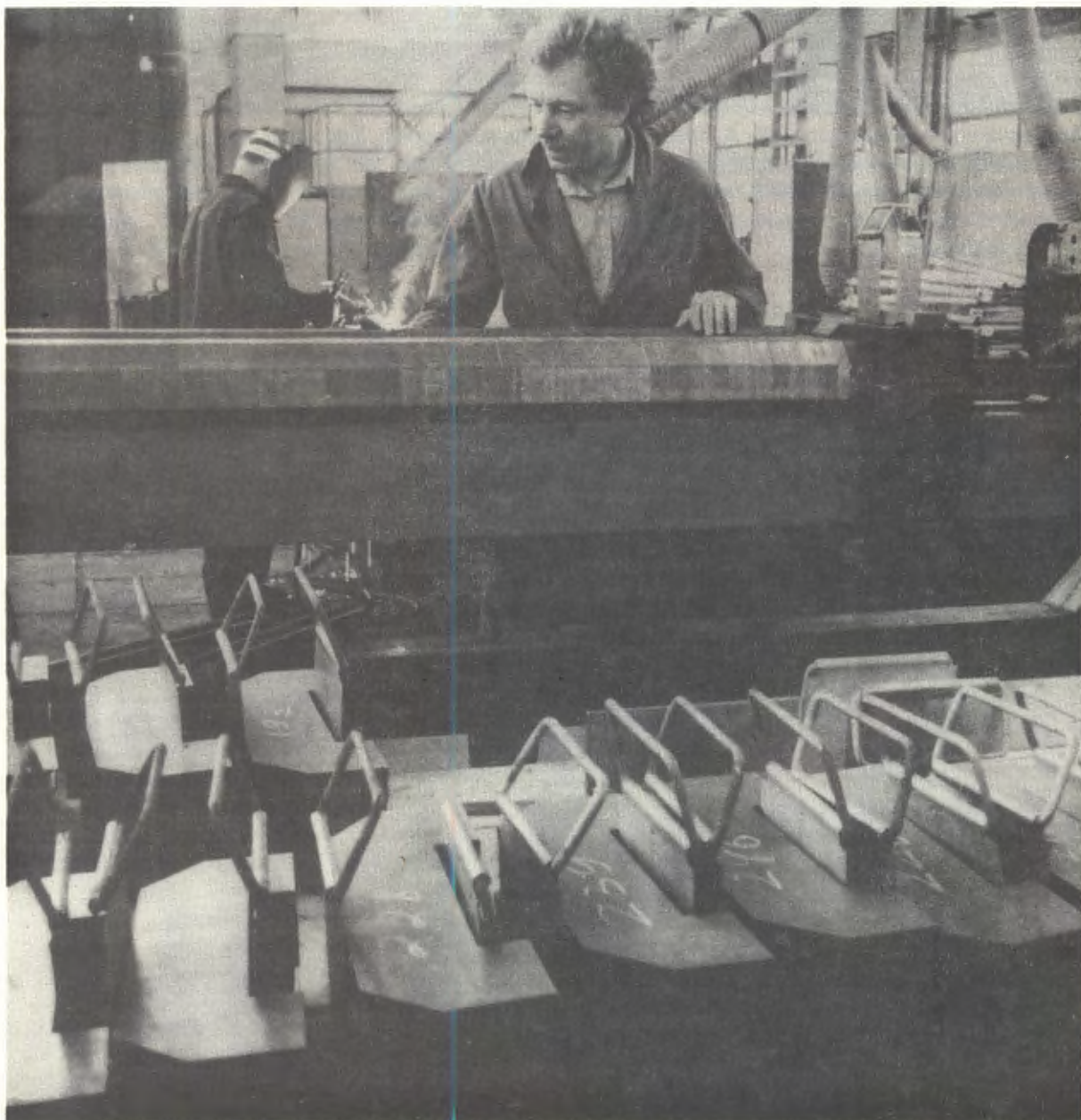
Сборка дипольных магнитов нуклотрона.
