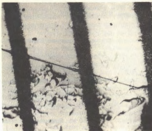
Рис.1. Микрофотография протравленного кристалла оливина, облученного через систему щелей ускоренными ионами {}^{59}\text{Ni} .
