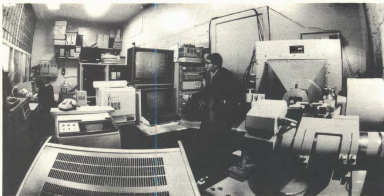
Рентгеновский дифрактометр КАРД-4 в Институте кристаллографии им. А.В.Шубникова АН СССР.
