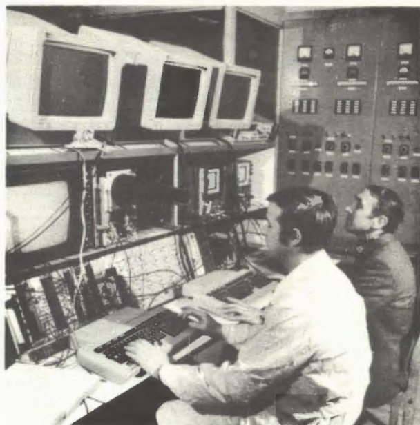
На базе мини- и микро-ЭВМ создан универсальный модуль пульта управления КУТИ-20, реализующий функции сбора, отображения информации и контроля параметров ускорителя.
