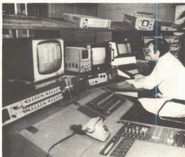
Пульт управления У-400. Отлажена и введена в эксплуатацию автоматизированная система контроля параметров ускорителя и каналов транспортировки пучков ионов.
