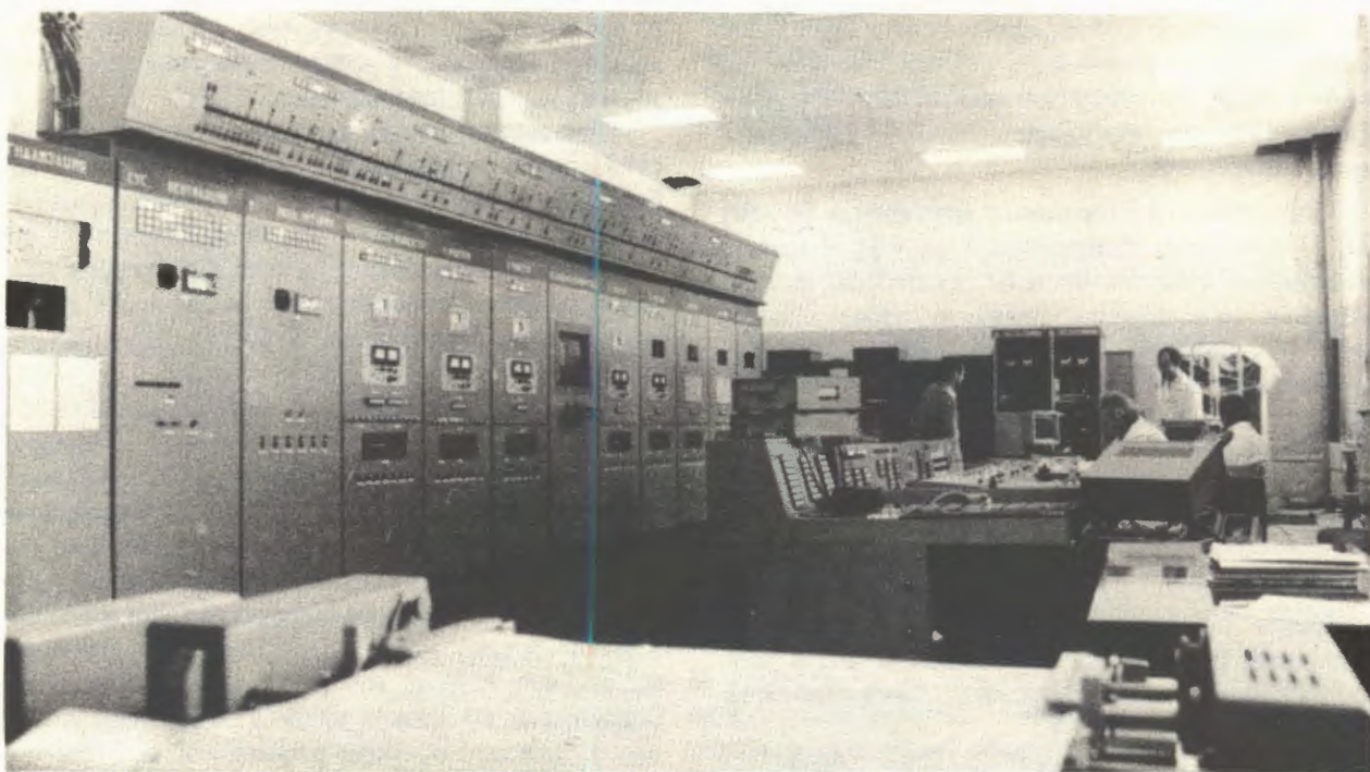
На создаваемом в лаборатории линейном индукционном ускорителе электронов ЛИУ-30 осуществлена проводка пучка через инжекторный и первый ускоряющий участок. Получена энергия электронов 5,2 МэВ при токе в импульсе 25 А. На снимке: пульт управления ЛИУ-30.
