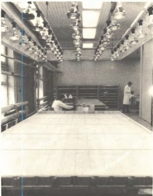
Участок для изготовления больших дрейфовых камер (2x4 м) "Нейтринного детектора".
