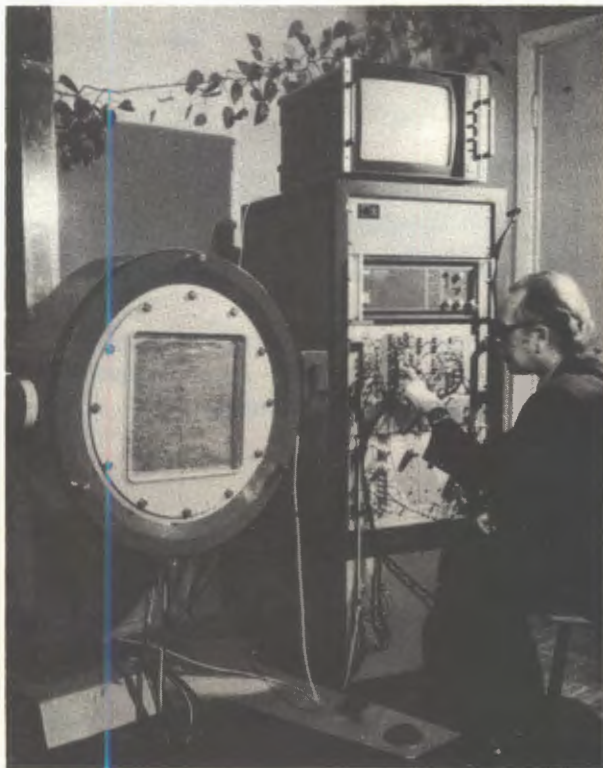
Гамма-камера нового типа с высоким пространственным разрешением, предназначенная для изучения структуры органов человека.
