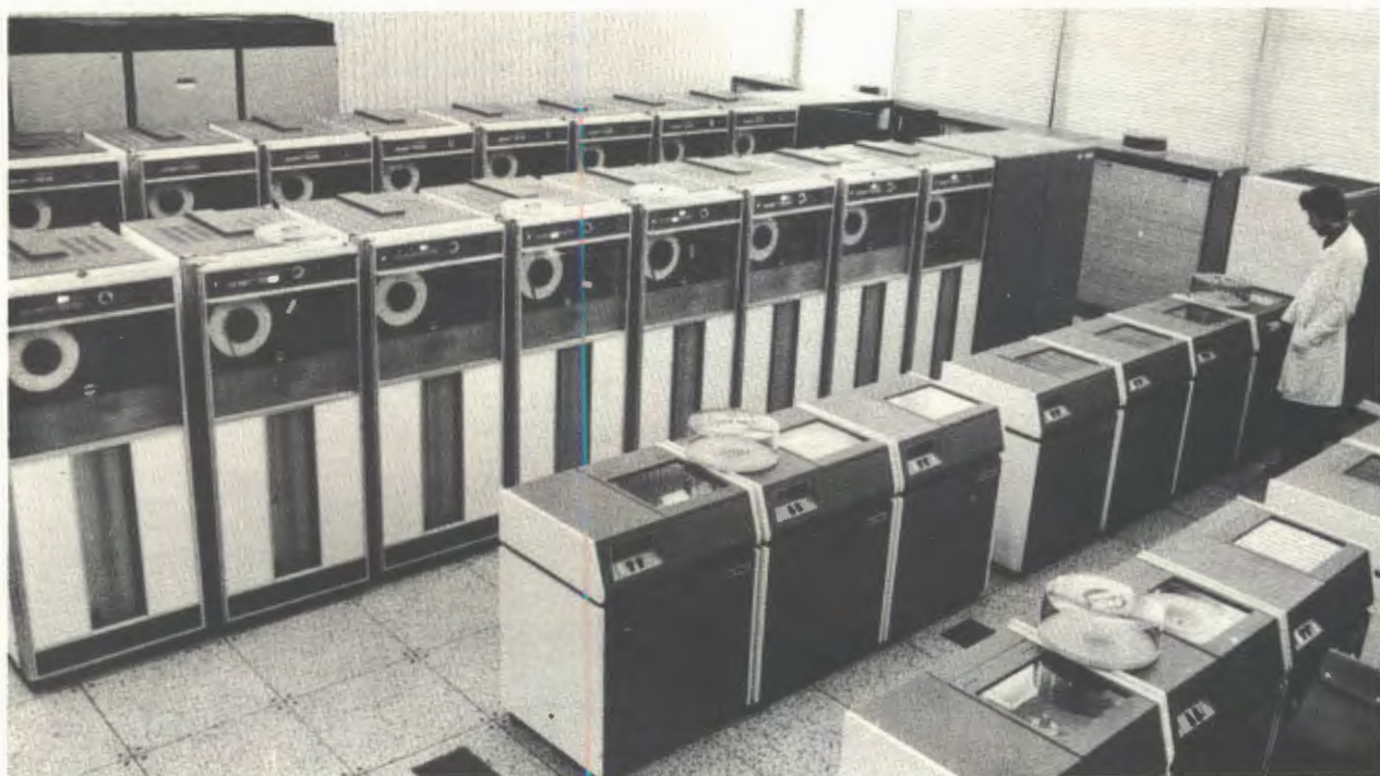
Объем оперативной памяти на магнитных дисках ЭВМ ЕС-1060 увеличен более чем в два раза.
