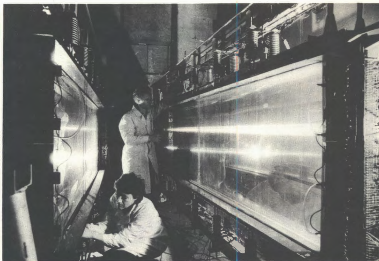
Дрейфовые камеры 3 \times 0,8 \text{ м}^2 установки "Позитроний". В камерах используется самогасящийся стримерный режим, обнаруженный и исследованный в Лаборатории ядерных проблем.
