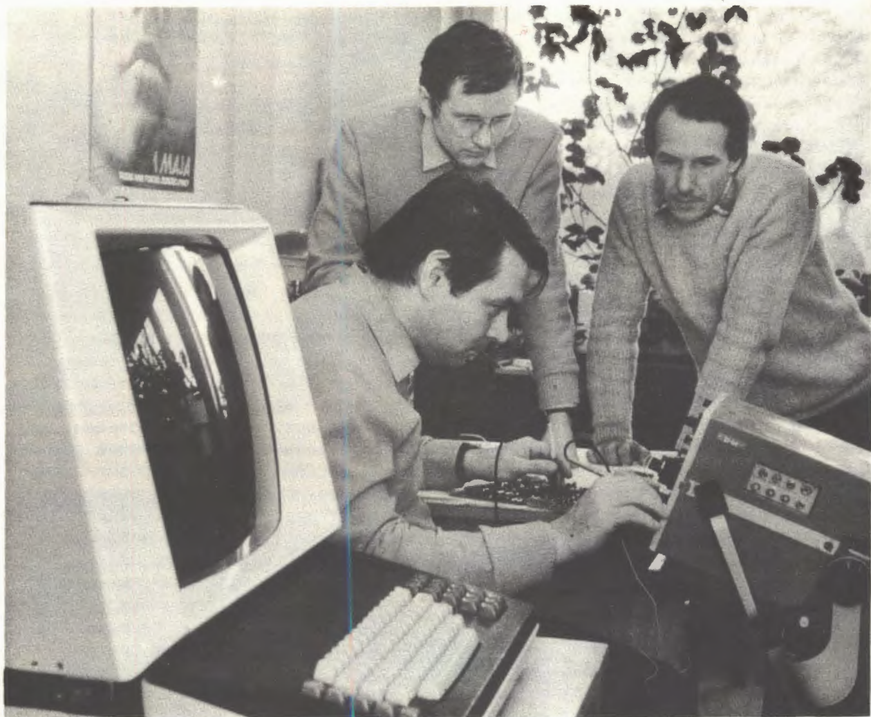
Наладка макета дисплейного монитора для графической системы на основе мультимикропроцессорного интеллектуального терминала и ЭВМ K1630.
