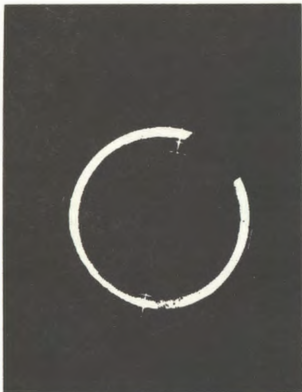
Рис.5. Автограф электронной компоненты, частично поглощенной "перехватчиком".
