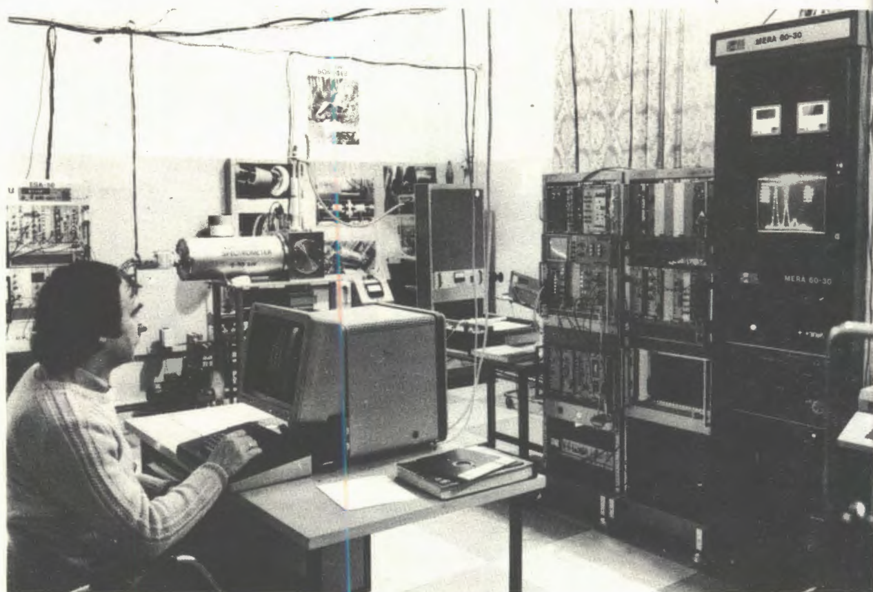
Прецизионный измерительный комплекс для амплитудных и временных измерений характеристик радионуклидов со спектрометрическими детекторами, работающими на линии с микро- и мини-ЭВМ.
