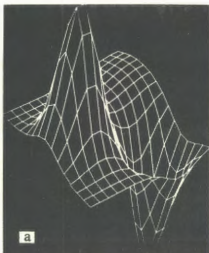
Рис. 54. Удаленная дисплейная станция ЭВМ БЭСМ-6 позволяет выводить в режиме диалога на экран графического дисплея как график функции двух переменных (а), так и фрагмент этого графика (б).
