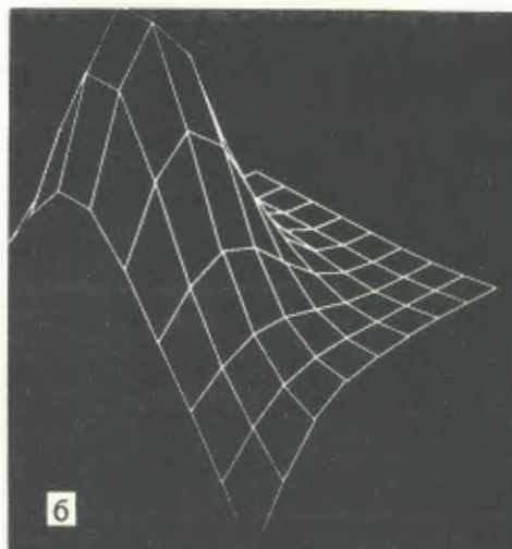
Рис. 54. Удаленная дисплейная станция ЭВМ БЭСМ-6 позволяет выводить в режиме диалога на экран графического дисплея как график функции двух переменных (а), так и фрагмент этого графика (б).
