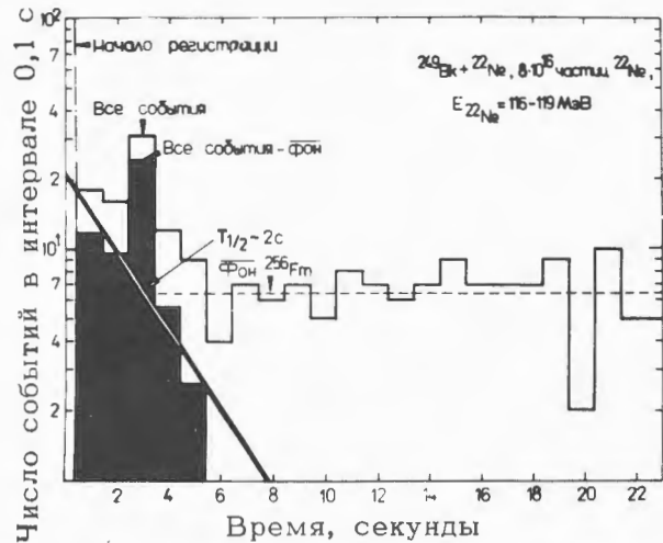
Рис. 26. Распределение треков осколков спонтанного деления в реакции ^{249}\text{Bk} + ^{22}\text{Ne} при энергии ионов ^{22}\text{Ne} , равной 116-119 МэВ в лабораторной системе.
