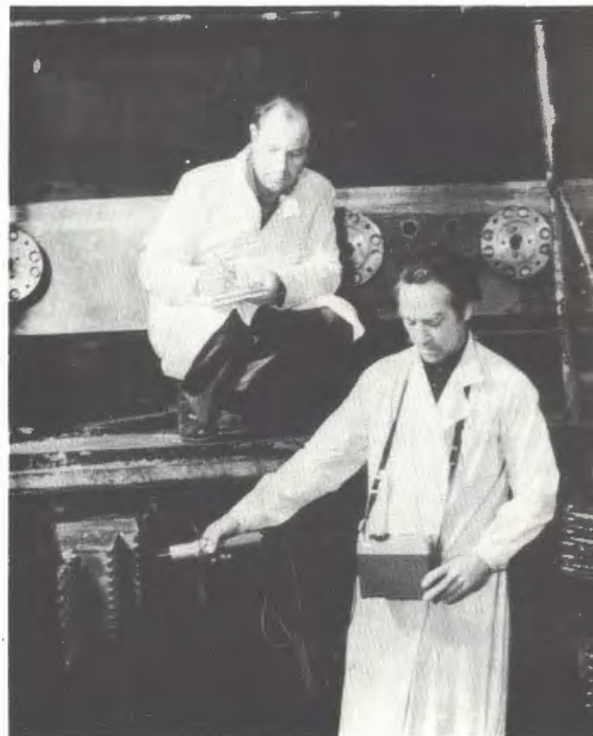
Дозиметрический контроль в главном зале синхроциклотрона при демонтаже ускорителя.
