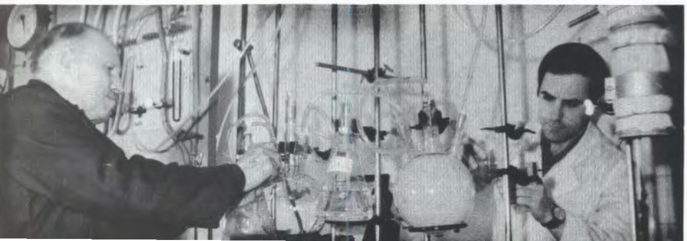
Подготовка опытов по переносу продуктов ядерных реакций методом аэрозольной струи.
