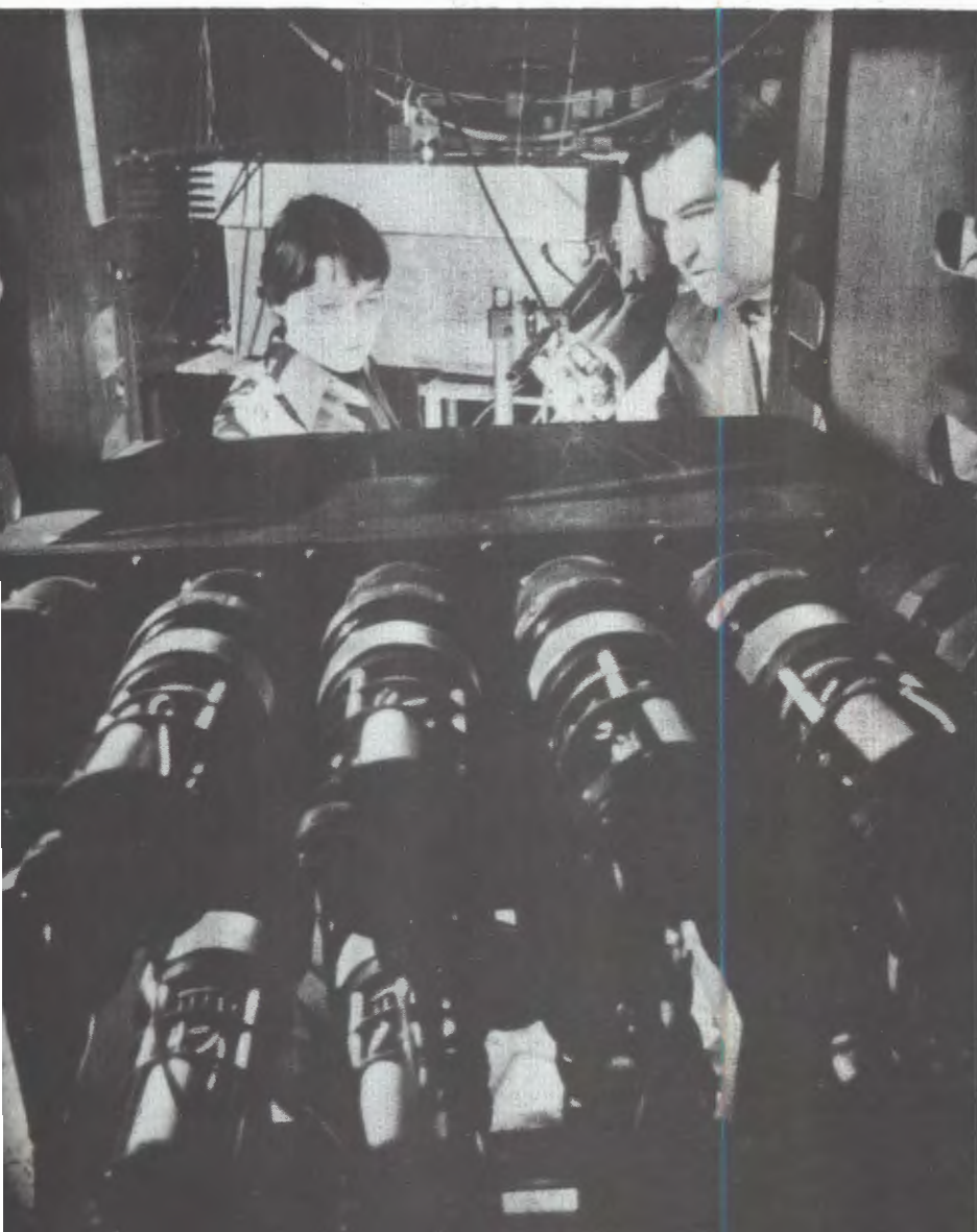
Сборка модуля из искровых камер установки "Гиперон", предназначенной для исследования гиперзарядово-обменных процессов на пучках \pi^- и K^- мезонов ускорителя ИФВЭ.
