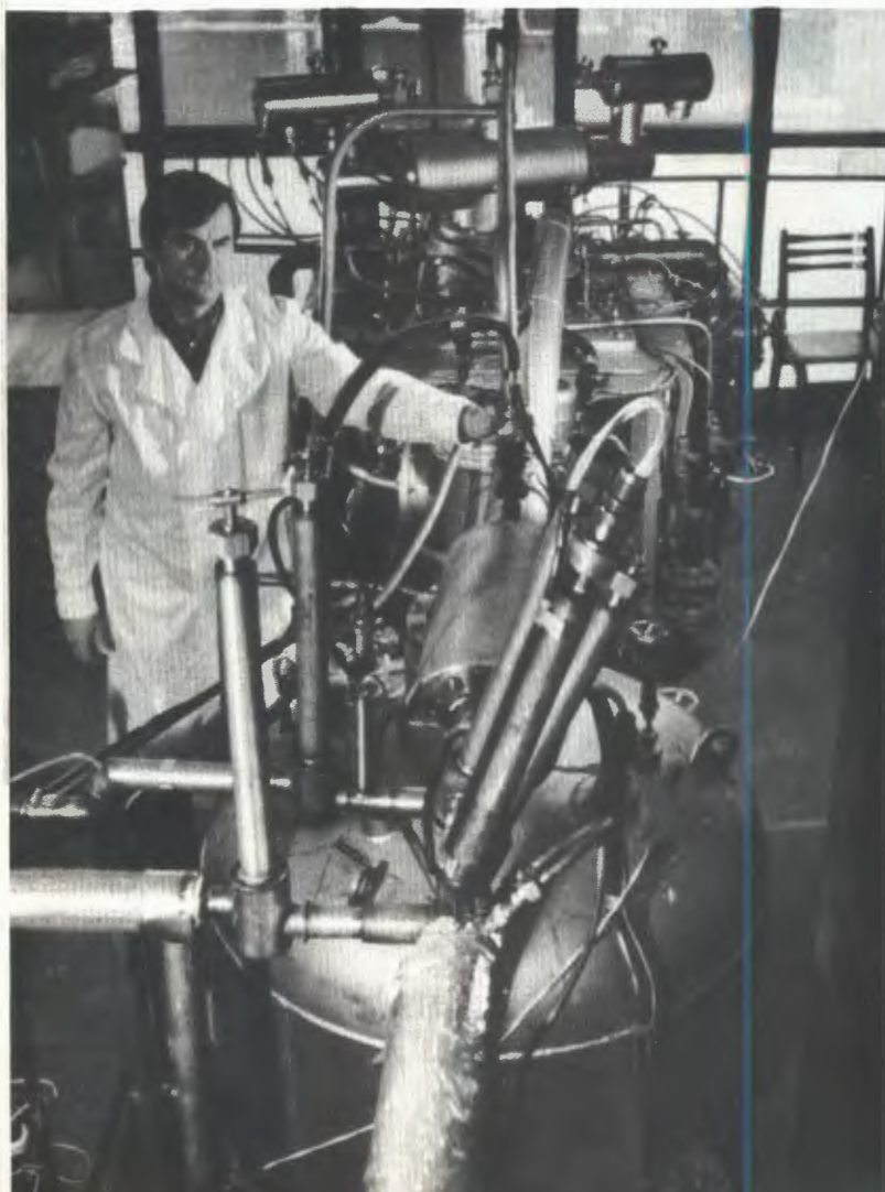
Первая очередь стенда криогенных систем УНК. Стенд позволяет исследовать различные потоки гелия в широком интервале параметров.
