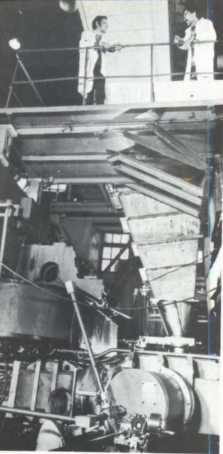
Выполнена серия экспериментов по дифракционному взаимодействию протонов и легких ядер, а также фрагментации различных ядер на внутреннем пучке синхрофазотрона с использованием различных тонких мишеней. На снимках: отдельные моменты работы на спектрометре ядер ошдачи.
