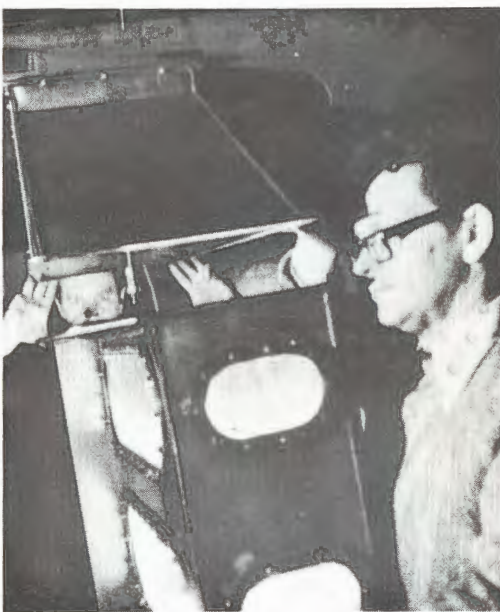
Модули черенковских счетчиков полного поглощения.
