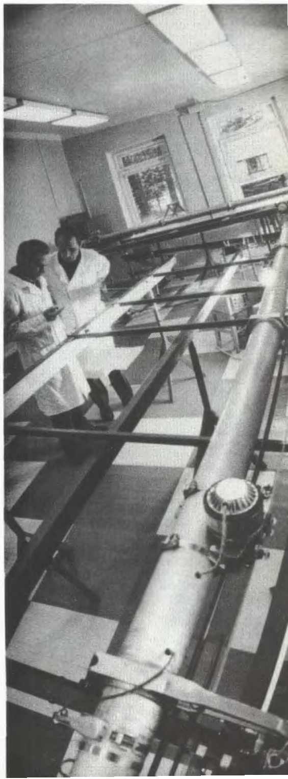
Станок для автоматизированной намотки рабочих проволок больших пропорциональных камер.
