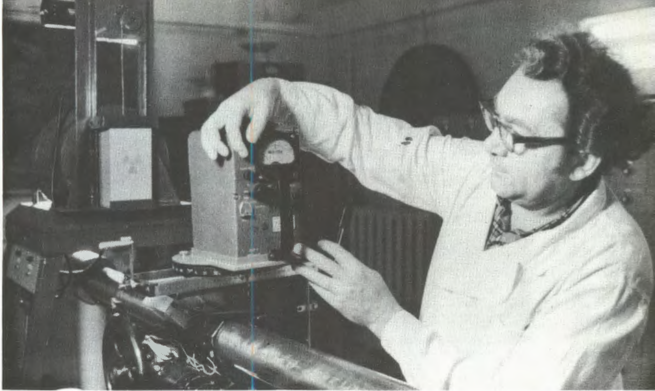
Контроль степени гамма-облучения сотрудников Института проводится с помощью поверочных установок гамма-дозиметров. На снимке: поверочная установка дозиметров с прибором ПМР-1.
