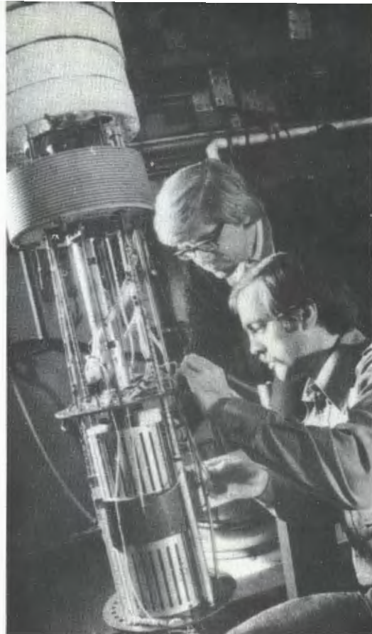
Для исследований, связанных с проектом жесткофокусирующего ускорителя релятивистских ядер, создан сверхпроводящий магнит, предназначенный для калибровки датчиков магнитного поля. Напряженность поля составляет 8 Т при неоднородности 10^{-5} .
