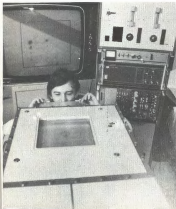
Для изучения биологических объектов, меченных радиоактивными изотопами, создан прибор на основе пропорциональной камеры.
