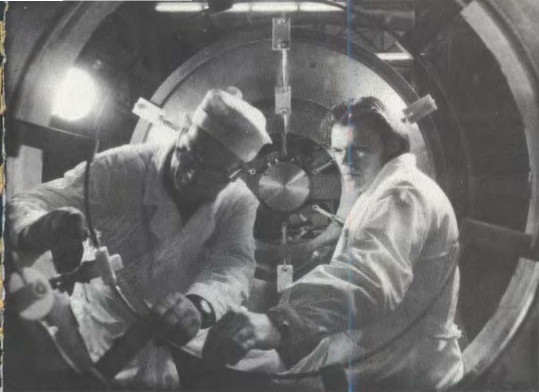
Монтаж системы быстрого поля в новом адгезаторе модели коллективного ускорителя.
