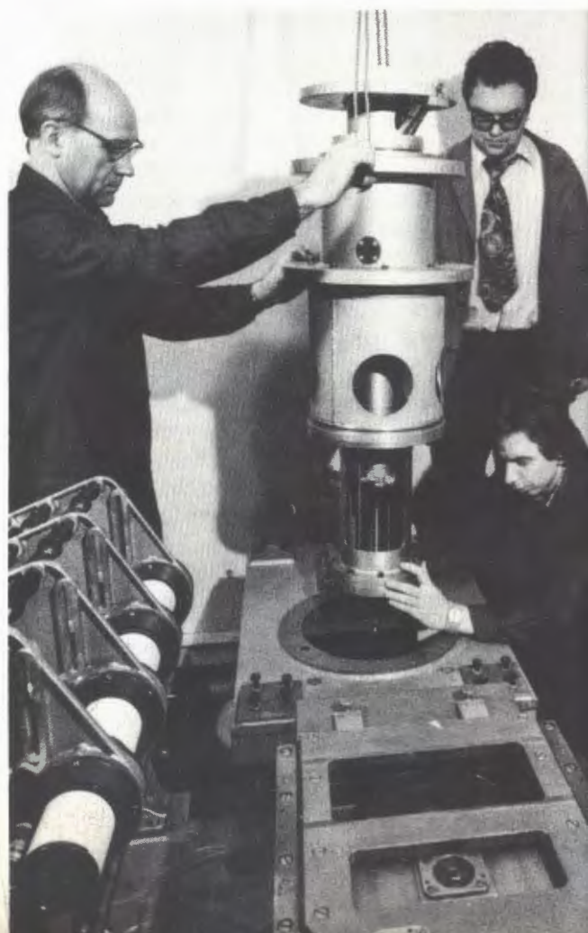
Монтаж перископа автоматической сканирующей установки "Спиральный измеритель-2".
