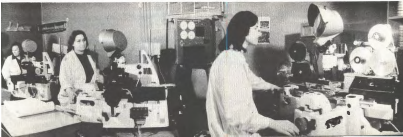
Измерительный зал полуавтоматических устройств ПУОС в проблемной лаборатории ТГУ. Здесь ведется обработка снимков ядерных событий, полученных на пузырьковых камерах ОИЯИ.
