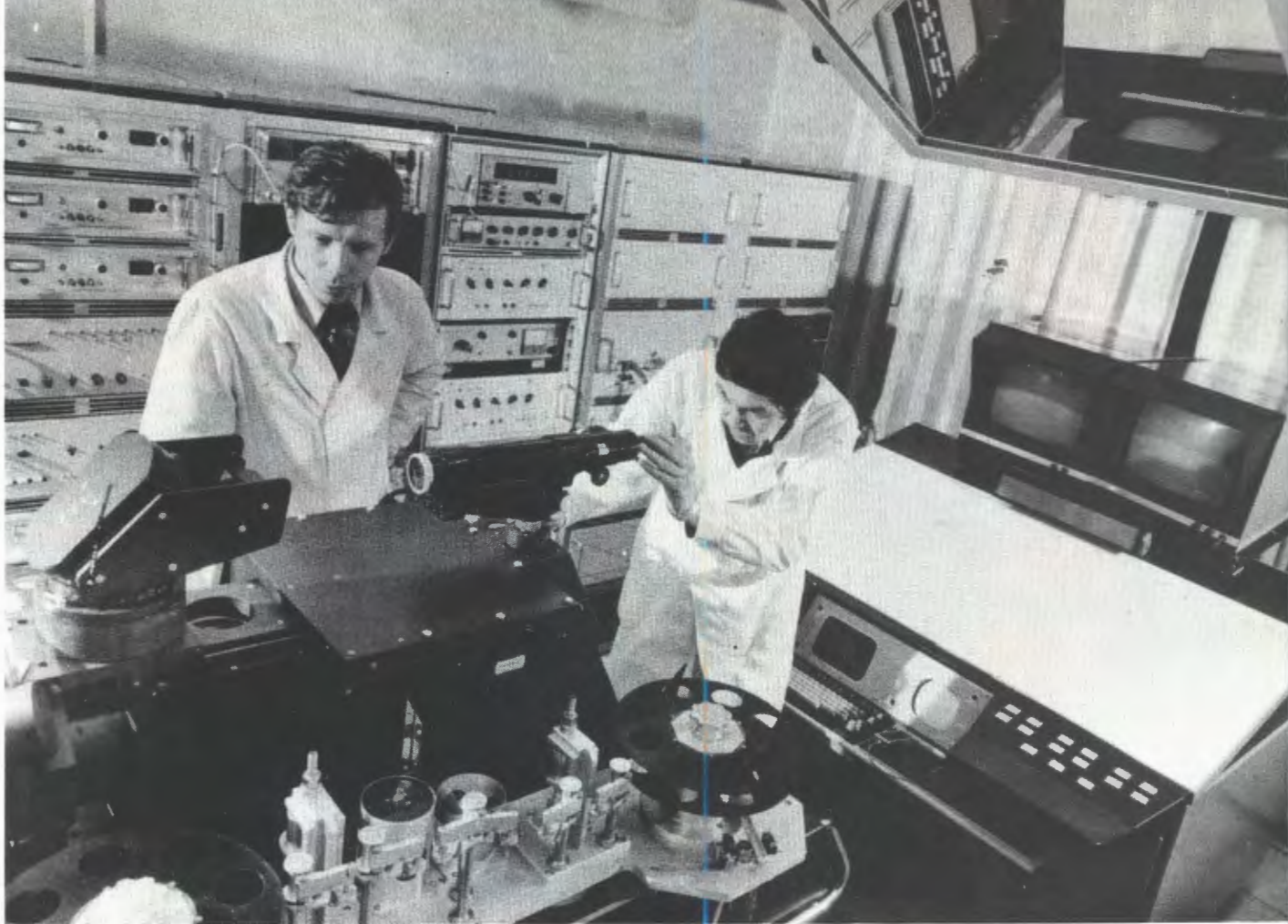
Создается автомат на электронно-лучевой трубке для обработки камерных снимков - АЭЛТ-2/160. На снимке: узел фильмового канала и пульта оператора автомата.
