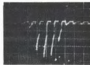
Рис. 50. Сечение электронного кольца на радиусе R = 2,9 см, снятое в инфракрасном синхротронном свете системой датчиков: а/ по оси R , б/ по оси z .
