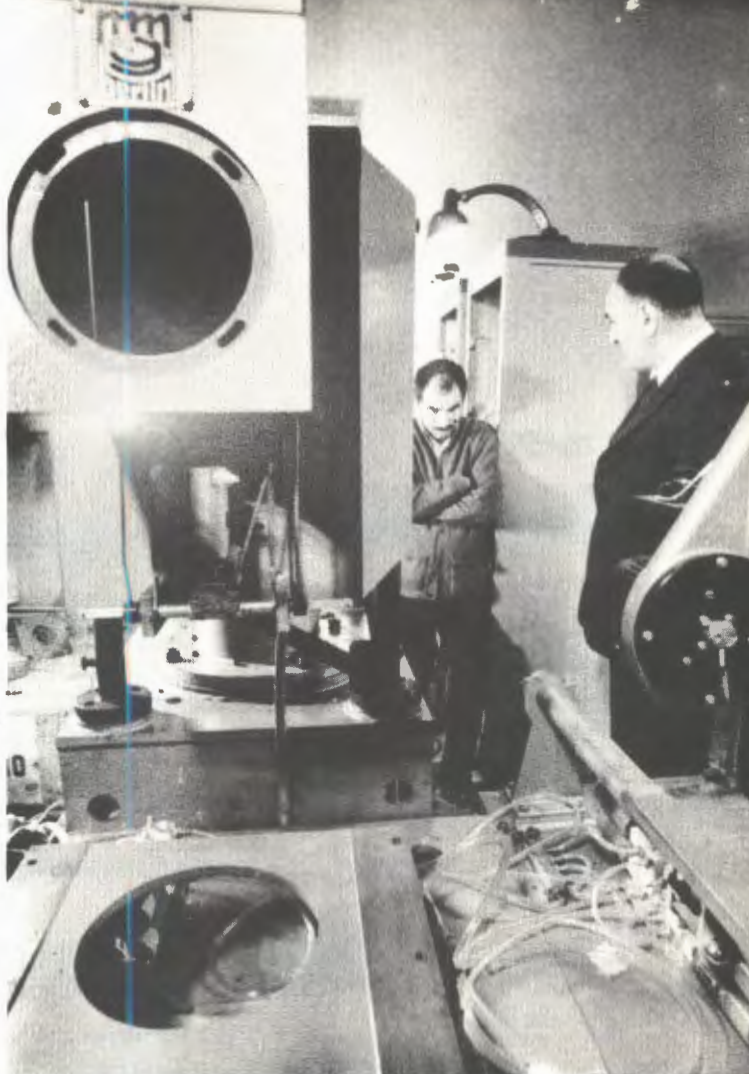
Отладка ЭВМ "Электроника-100", входящей в состав сканирующей системы СИ, на линии с аппаратурой измерителя.
