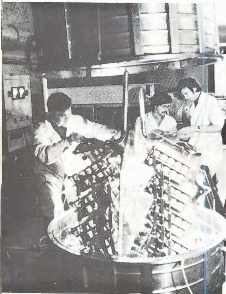
Настройка высоковольтного генератора установки. Монтаж пьезиметровой стримерной камеры.
