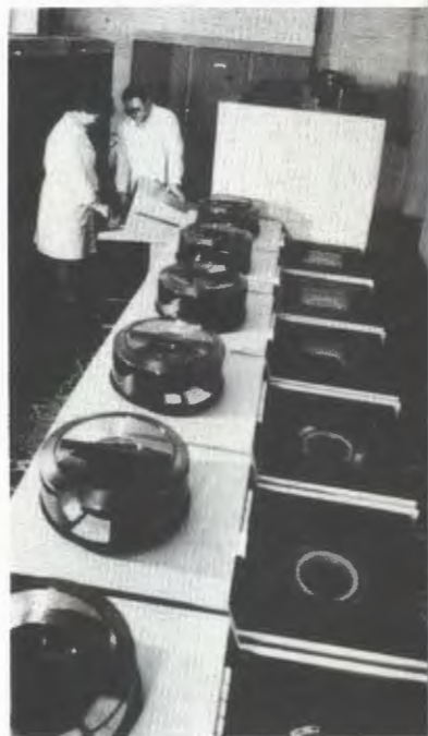
Введено в эксплуатацию новое оборудование, а также математическое обеспечение системы CDC-6500. Это позволило значительно повысить производительность центрального вычислительного комплекса Института. На снимках: проверка систем магнитных дисков и магнитофонов ЭВМ.
