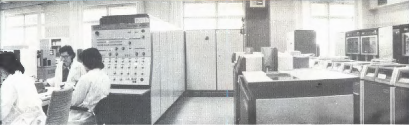
Измерительный центр Лаборатории ядерных проблем переоснащен современной вычислительной техникой. Здесь действует ЭВМ ЕС-1040 и несколько малых вычислительных машин.
