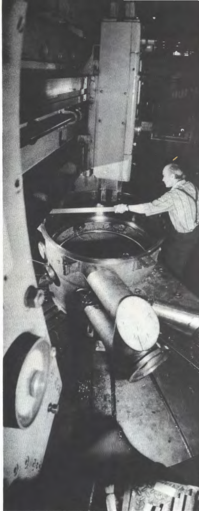
Создается новая камера адгезатора модели коллективного ускорителя. На снимке: чистовая обработка корпуса камеры на карусельном станке в ЦЭМ.
