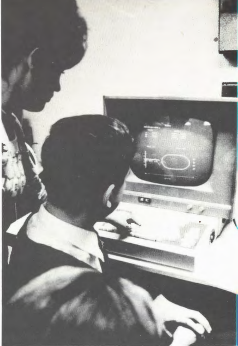
Удаленная дисплейная станция на линии с ЭВМ БЭСМ-6 используется для решения задач теоретической и экспериментальной физики в режиме диалога человек-ЭВМ.
