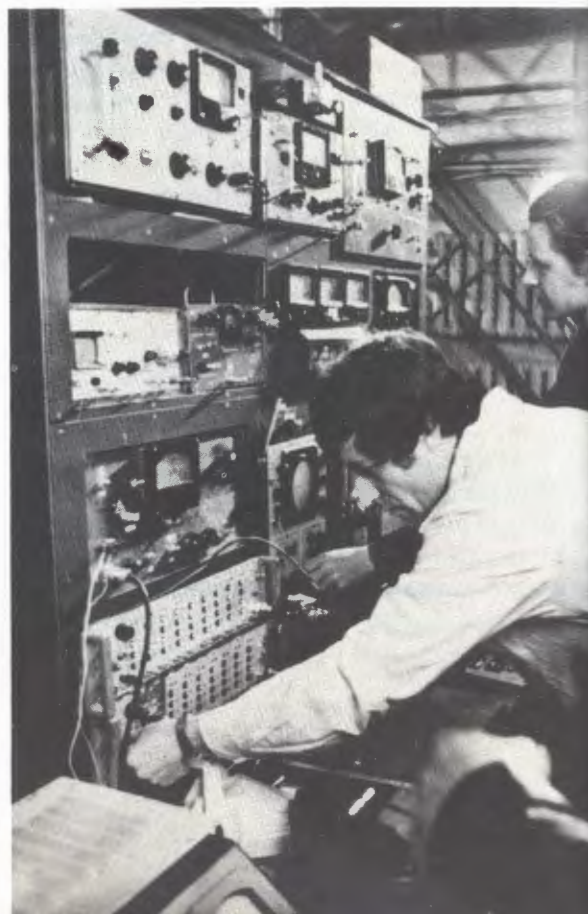
Узлы поляризованной протонной мишени: а/ система быстрого /10 с/ реверса поляризации нейтронов; б/ пульт управления установкой.
