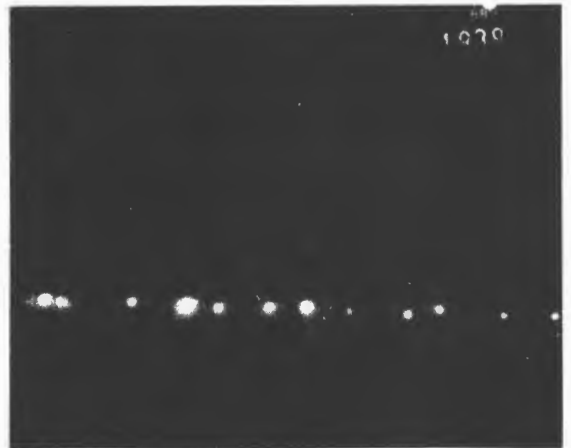
34. Фотография следа электрона в стримерной камере, наполненной водородом при атмосферном давлении с 0,5%-ной примесью метана.
