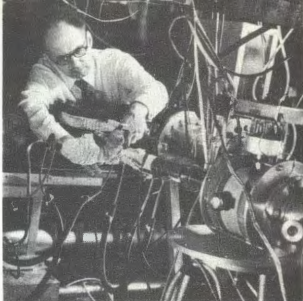
Источник поляризованных ионов для установки "Ф". На снимке: настройка поляриметра для измерения поляризации частиц на выходе источника.
