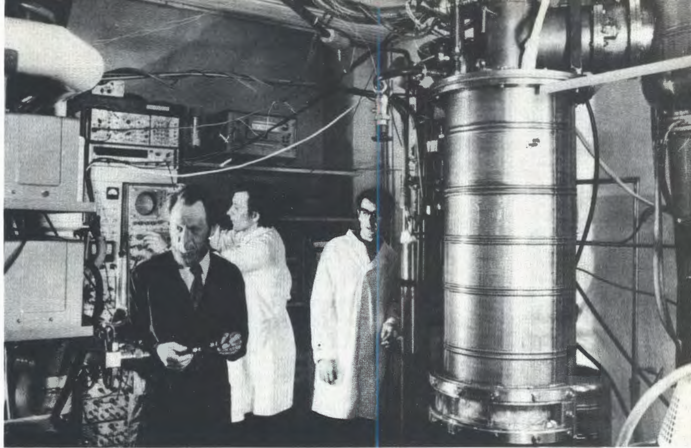
Криогенная система со сверхпроводящим магнитом /на снимке справа/ и система измерения степени поляризации водорода.
