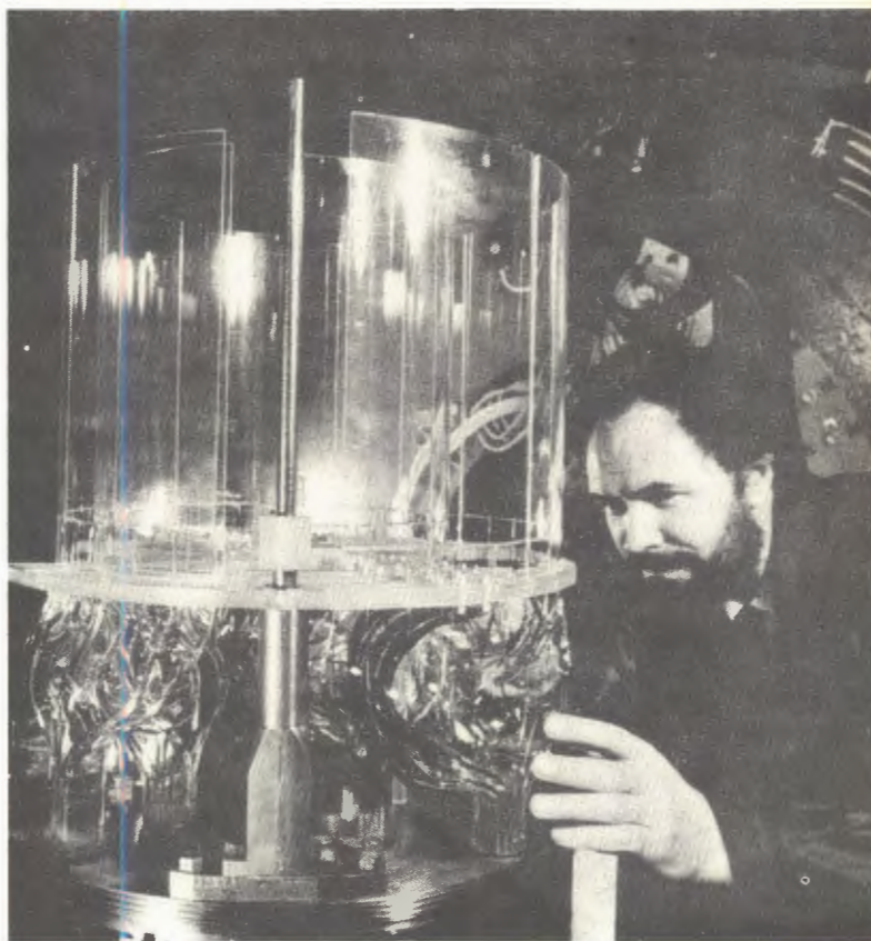
Сцинтилляционный годоскоп цилиндрического магнитного искрового спектрометра.
