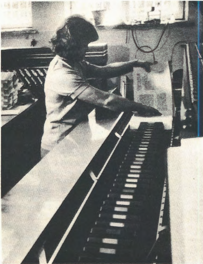
Освоенный в 1973 году листо-подборочный агрегат позволил полностью автоматизировать процесс брошюрования.
