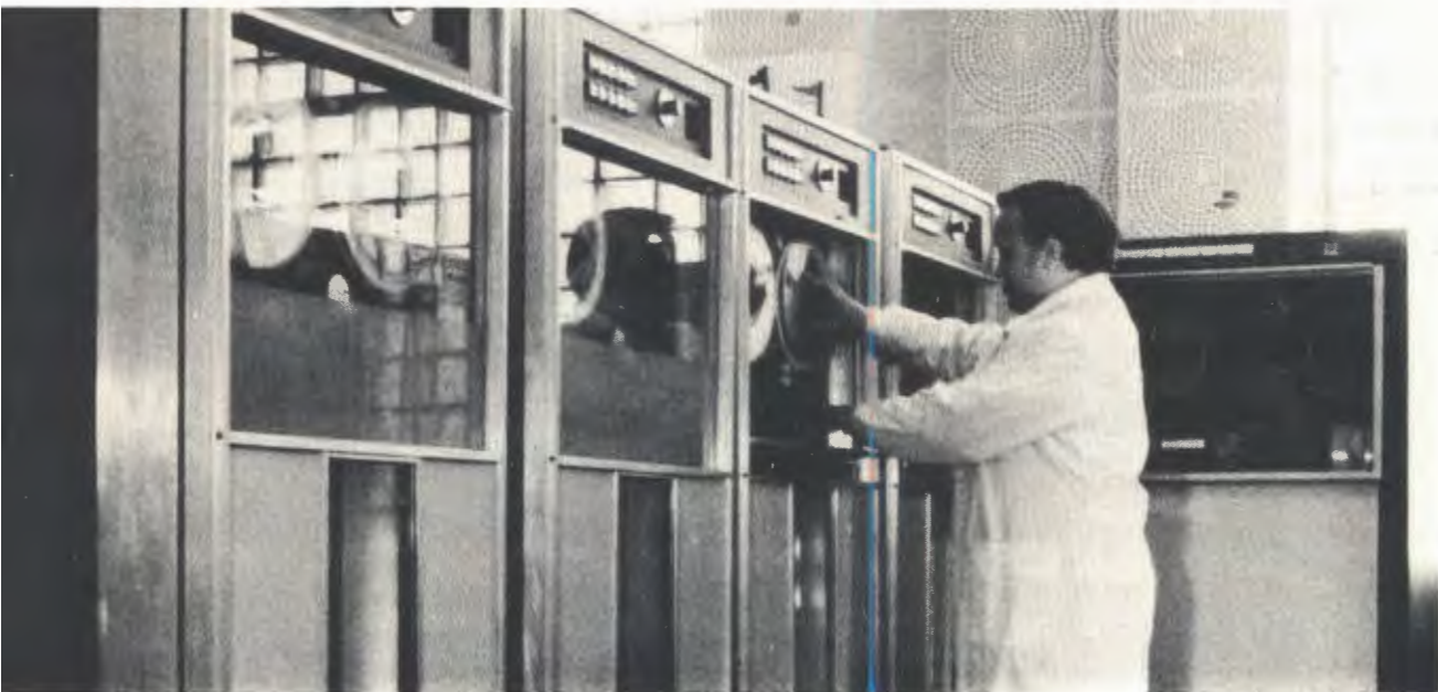
▲ Электронные вычислительные машины БЭСМ-6 и БЭСМ-4, функционирующие в ОИЯИ, оснащаются стандартными накопителями на магнитной ленте типа ЕС-5012.
