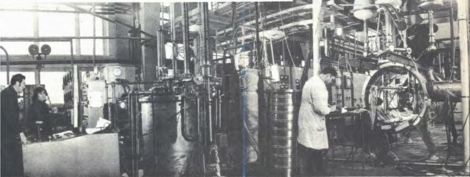
Сборка и испытания узлов криогенной высокочастотной ускорительной секции - кольцепрона, - предназначенной для отработки систем ускорителя на высокие энергии. Успешно проведена гелиевая заливка кольцепрона. В опытах используется многоцелевой гелиевый оживитель - рефрижератор, созданный в ОИЯИ.
