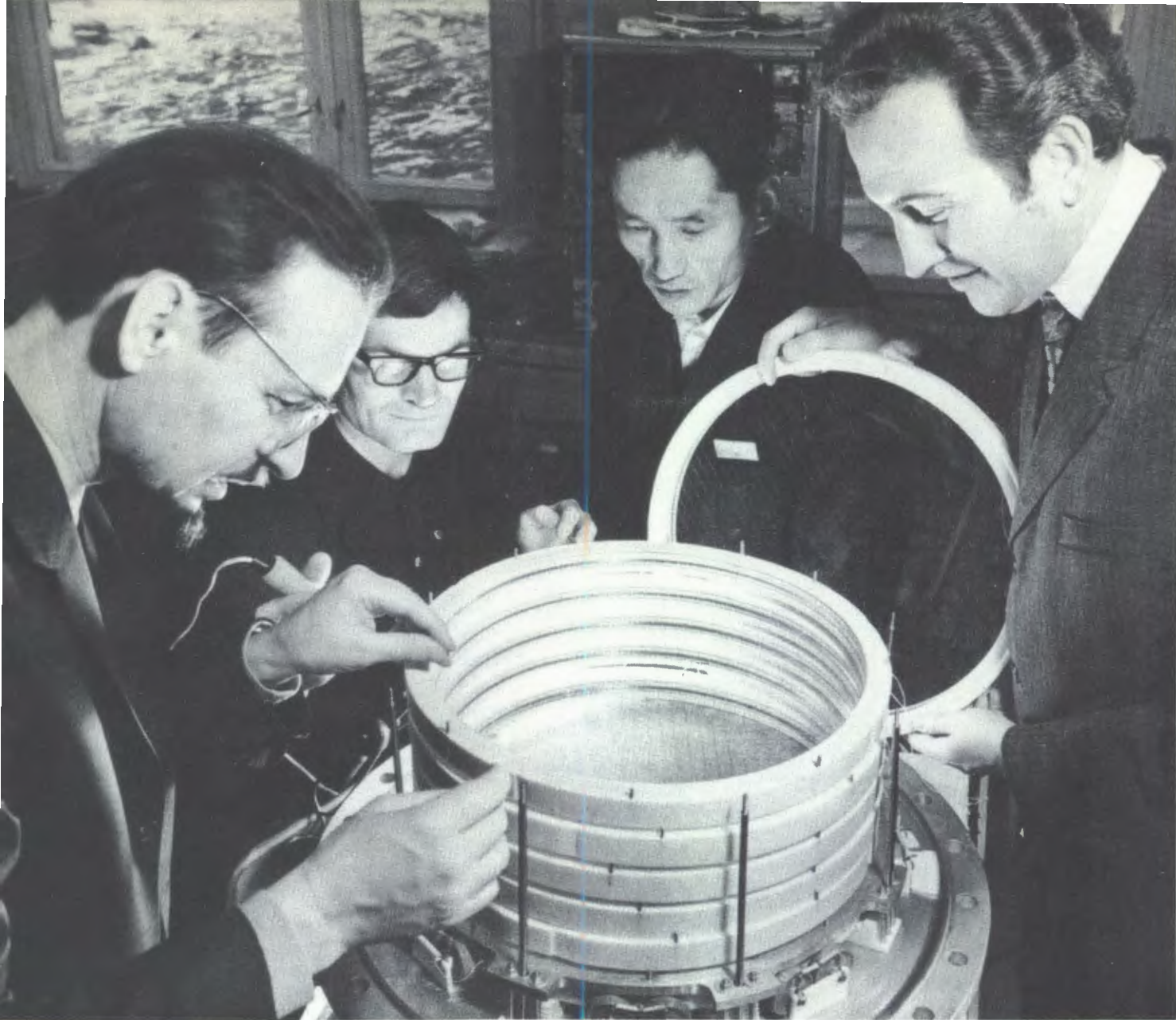
Многосекционная пропорциональная камера предназначена для регистрации альфа-частиц в редких реакциях, вызываемых нейтронами. Обладает большой рабочей площадью мишеней /около 1 м 2 /.
