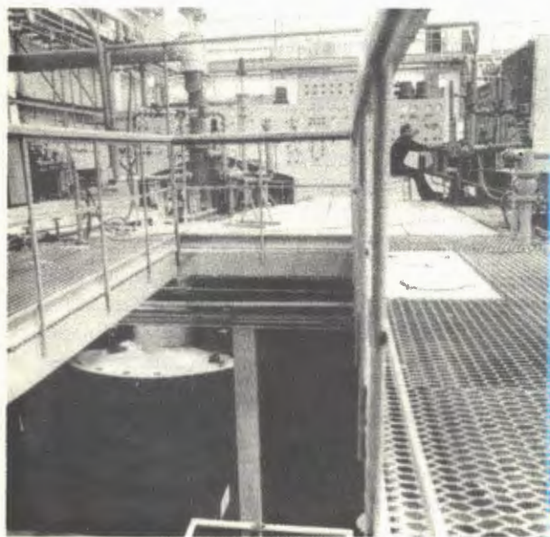
13. Двухметровая жидководородная пузырьковая камера ОИЯИ "Людмила" запущена на пучке протонов с энергией 35 Гэв ускорителя ИФВЭ /Серпухов/.
