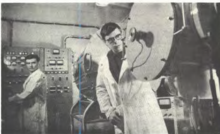
116. Испытания модели камеры для напыления сверхпроводящих пленок. На втором плане виден рабочий вариант камеры.
