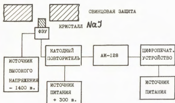
111. Блок-схема установки для измерения энергии и числа альфа-частиц, ускоренных в адгезаторе.
