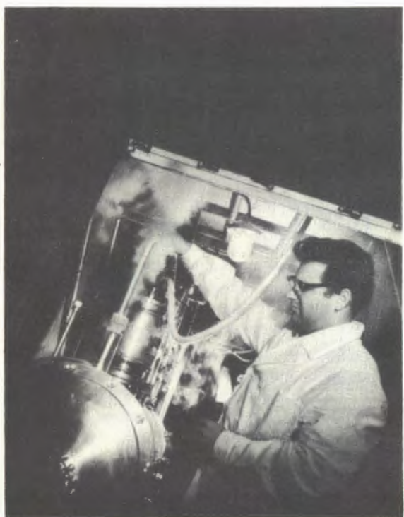
7. В опытах по исследованию регенерации K^0 -мезонов на серпуховском ускорителе используется 3-метровая жидководородная мишень.
