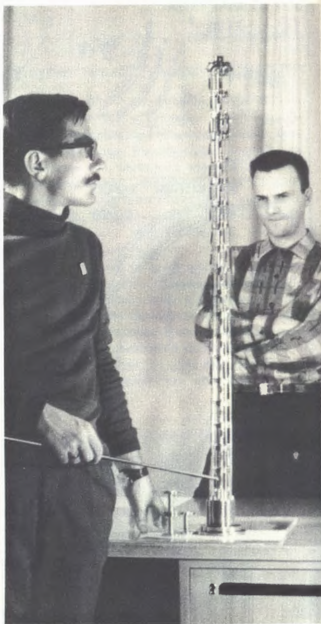
Рис. 91. Сверхвысоковакуумный электроннолучевой источник для получения ионов высокой зарядности, разрабатываемый в Лаборатории ядерных реакций. Вверху - В.И. Шербак и Е.Д. Донец.
