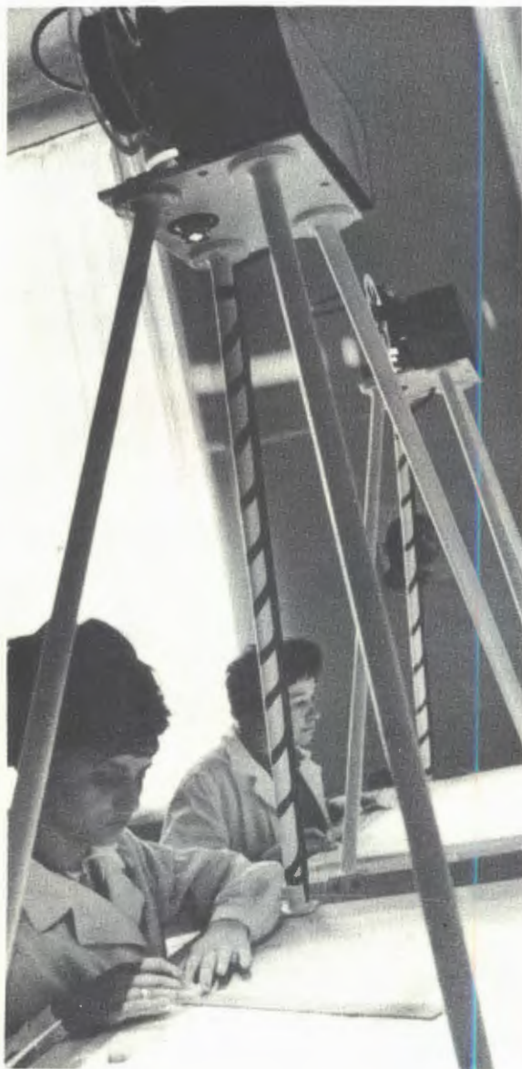
Рис. 85. Просмотровый стол для обработки снимков с искровых камер. Размеры экрана 1050 \times 750 \text{ мм}^2 . Прибор позволяет обрабатывать неперфорированную фотопленку шириной 35 мм с увеличением \times 20 . Отсчетное устройство дает возможность измерять координаты с помощью фотодатчиков.
