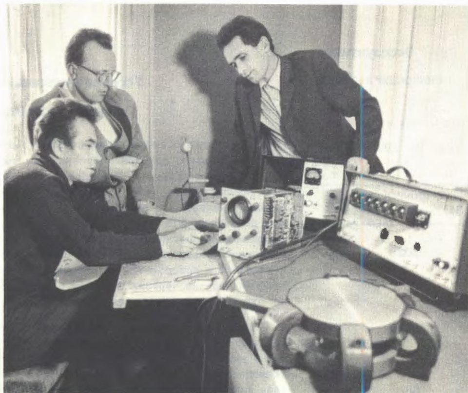
Рис. 88. Для исследований, связанных с созданием новых ускорителей, в Лаборатории ядерных проблем создан ряд прецизионных приборов для измерения магнитных полей. На снимке: С.А. Ивашкевич, Ю.Н. Денисов, П.Т. Шишляников.
