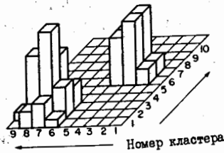
Рис. 32. Пример распределения энергии в ячейках электромагнитного калориметра.
