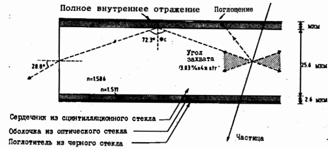
Рис. 4. Геометрические и оптические параметры сцинтилляционного световода.
