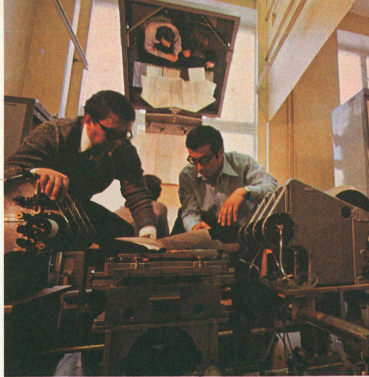
Настройка сканирующего автомата "Спиральный измеритель" для обработки многолучевых событий с трековых камер.
