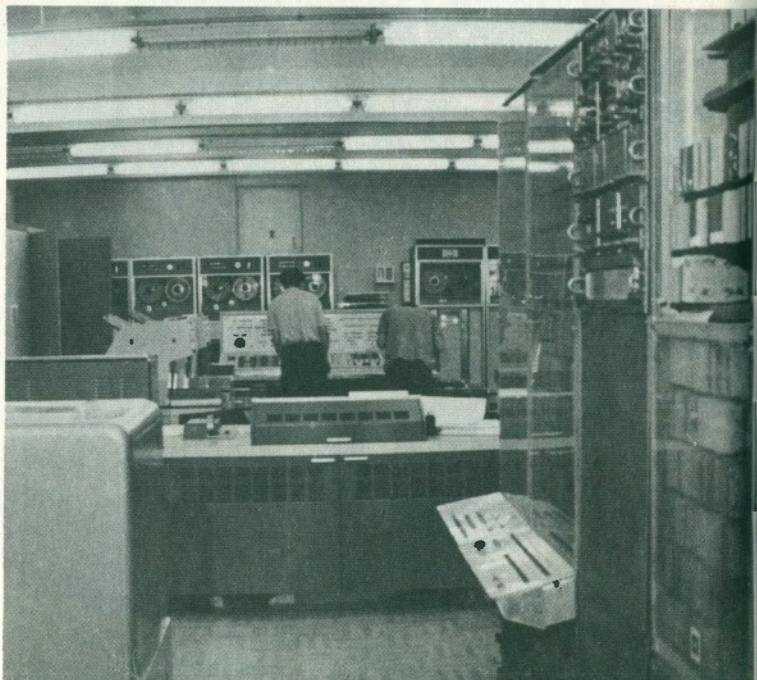
Электронный процессор для автоматизированной обработки камерных снимков со сканированием "бегущим лучом".
