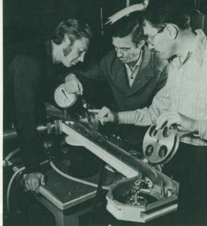
Высокочувствительная установка с лентой-сборником ядер отдачи, используемая в работах по синтезу трансураниевых элементов.
