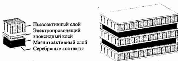
Рис. 1. Принципиальная схема структуры МЭ преобразователя.
