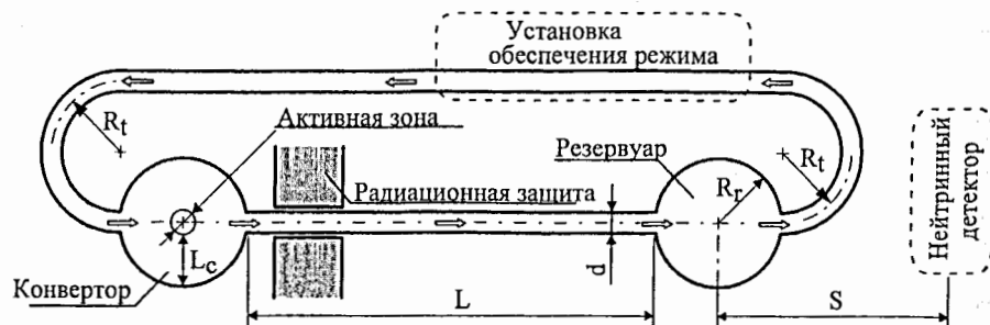
Рис. 5. Схема установки реактор-конвертор-резервуар, работающей в динамическом режиме прокачки жидкого литийсодержащего вещества конвертора.
