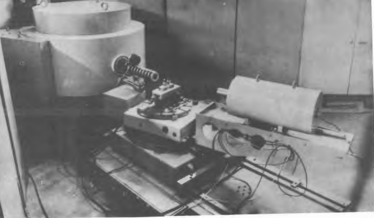
Универсальный двух- осный спектрометр медленных нейтронов SPN-100 для исследова- ния (n- \epsilon ) взаимодей- ствия на моно- кристалле ^{186}\text{W} .
