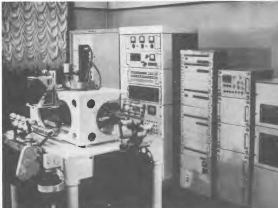
Автоматический прибор со сканирующим пятном ПСП-1, на котором ведется обработка фотографий с искровых камер. Производительность установки - от 40 до 280 событий в час.
