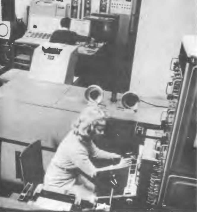
Сканирующий автомат АЭЛТ-1 используется для обработки снимков с искровых камер. На переднем плане: оператор ведет "разговор" с ЭВМ, используя дисплей-монитор, на заднем плане - ЭВМ БЭСМ-4, управляющая работой автомата.
