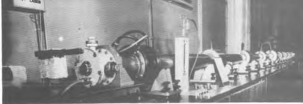
Лазер с \text{CO}_2 мощностью 400 Вт. ▶
