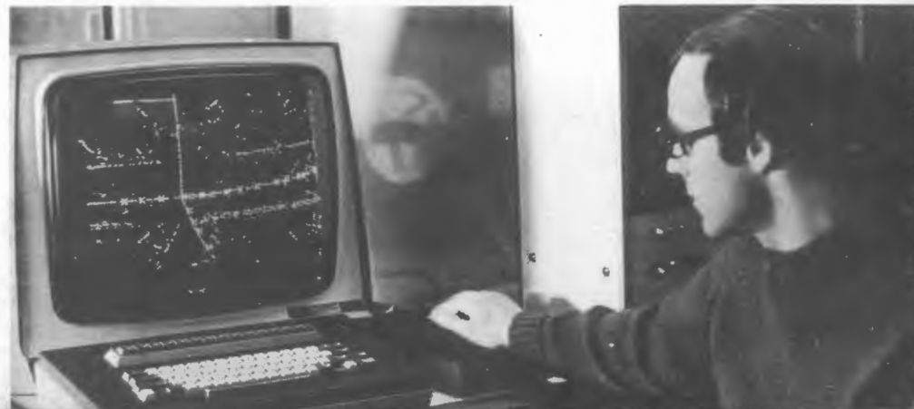
Малая вычислительная машина ЭВМ ТРА-1 с графическим дисплеем предназначена для обработки снимков с пузырьковых камер на сканирующих автоматах.
