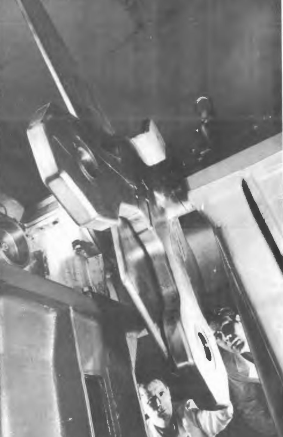
Испытания рабочего макета подвижного отражателя - одного из основных узлов ИБР-2.
