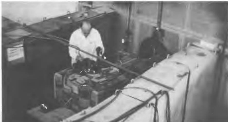
Диффузионная камера для регистрации взаимодействий тепловых нейтронов в аргоне.
