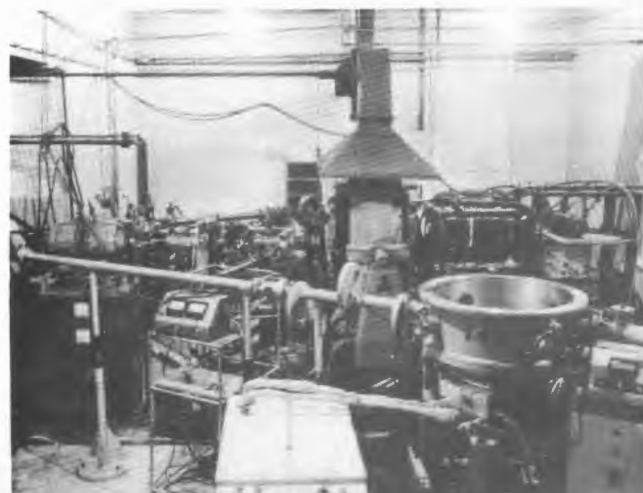
Аппаратура с ка- мерой-мишенью для измерения угловых распределений прото- нов в ядерных реак- циях (d-p) с помо- щью полупроводнико- вых детекторов.
