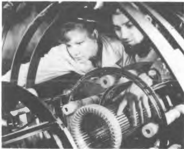
Адгезатор - цент- ральная часть коллек- тивного ускорителя. Здесь формируется кольцевой сгусток час- тиц.
