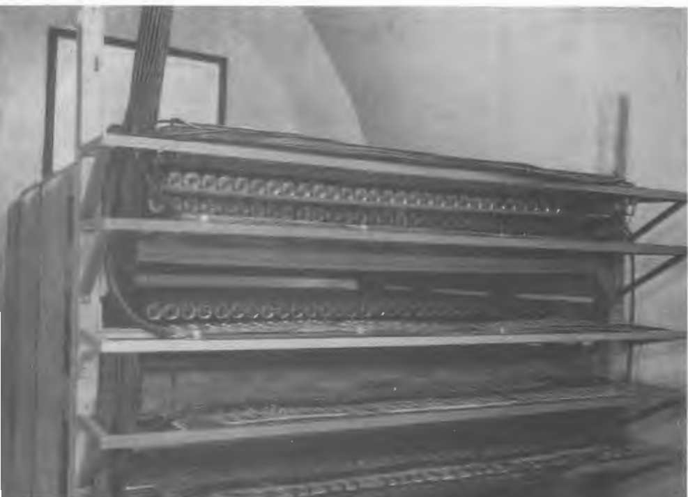
Трехосевой кристаллический спектрометр, используемый на атомном реакторе ЦИФИ. Спектрометр изготовлен совместно с Институтом атомной энергии им. И.В.Курчатова /СССР/.
