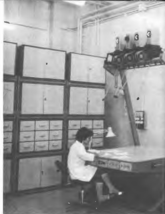
Устройство для изготовления проволочной памяти ЭВМ, используемое в ЦИФИ.
