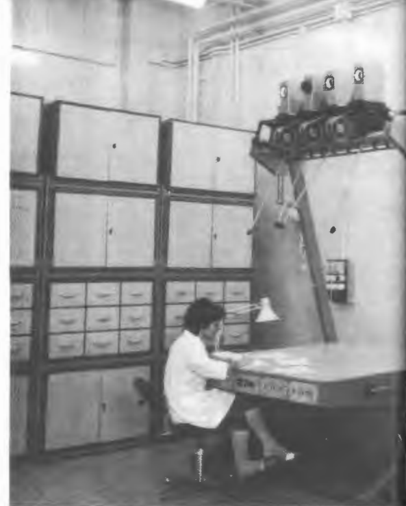
Устройство для изготовления проволочной памяти ЭВМ, используемое в ЦИФИ.
