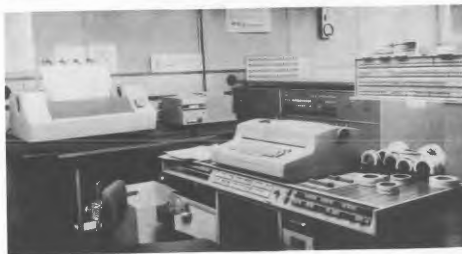
Электронная вычис- лительная машина КАР-65, которая уп- равляет полуавтома- тически измери- тельными приборами для обработки снимков с пузырьковых камер. Машина построена в Институте экспери- ментальной физики Варшавского универ- ситета.
