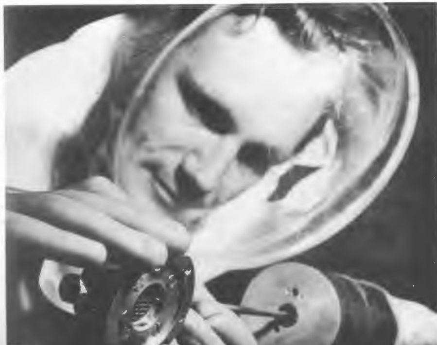
Радиохимик В.З.Белов производит установку мишени в газохроматографической системе для экспрессного химического анализа продуктов ядерных реакций.
