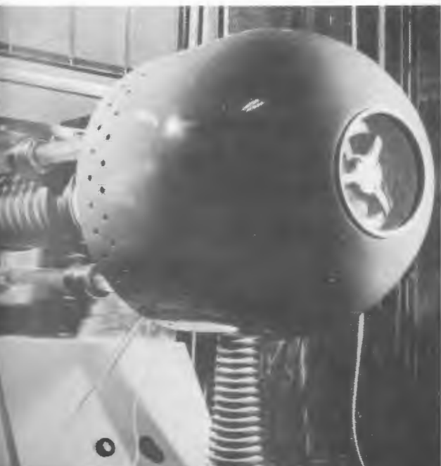
В Дубне на базе изготовленного в Венгрии нейтронного генератора ученые из ДРВ выполнили исследования ядерных реакций для применения полученных данных в активационном анализе.
