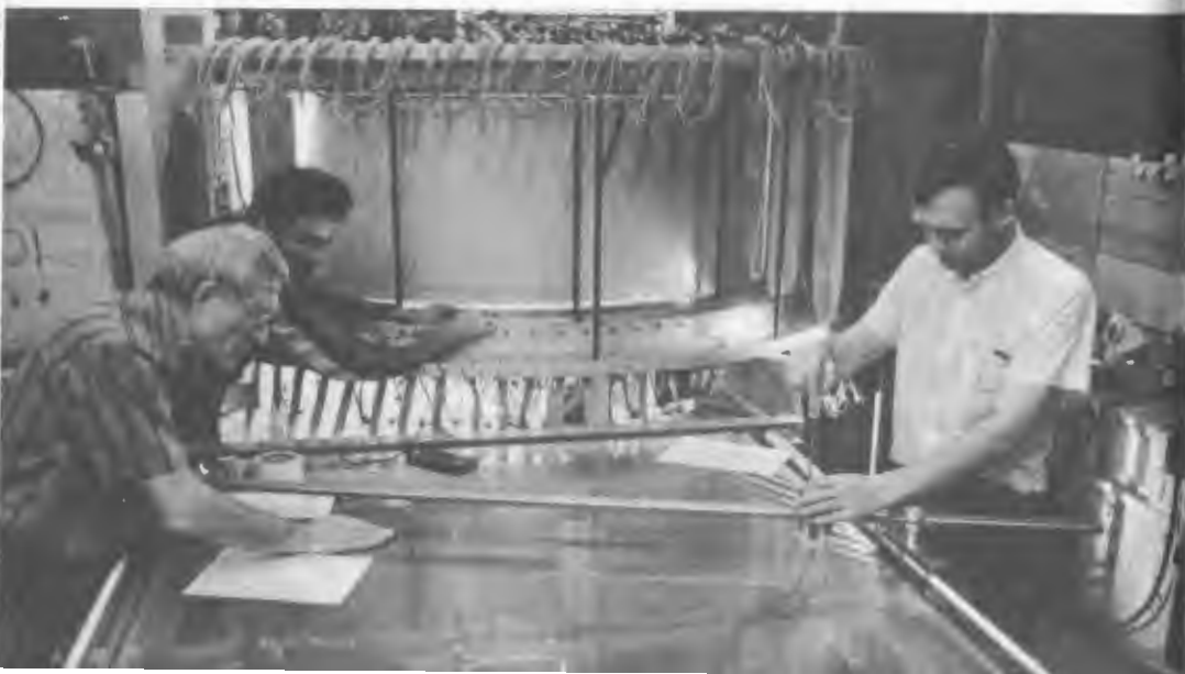
Монтаж многопроволочной камеры с цилиндрической чувствительной поверхностью для эксперимента DISTO на ускорителе SATURNE (Франция)
