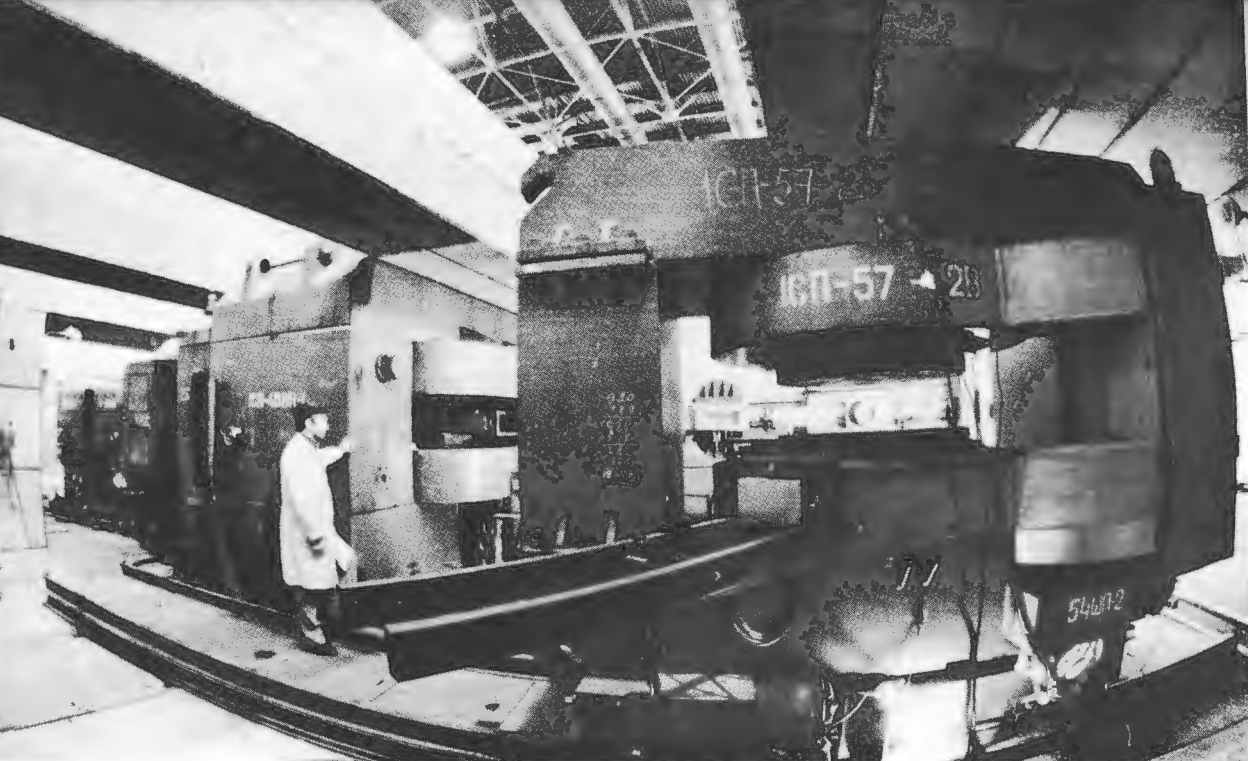
Двухплечевой магнитный спектрометр МАСПИК-2, предназначенный для исследования фрагментации релятивистских дейтронов и \alpha -частиц на ядрах.
