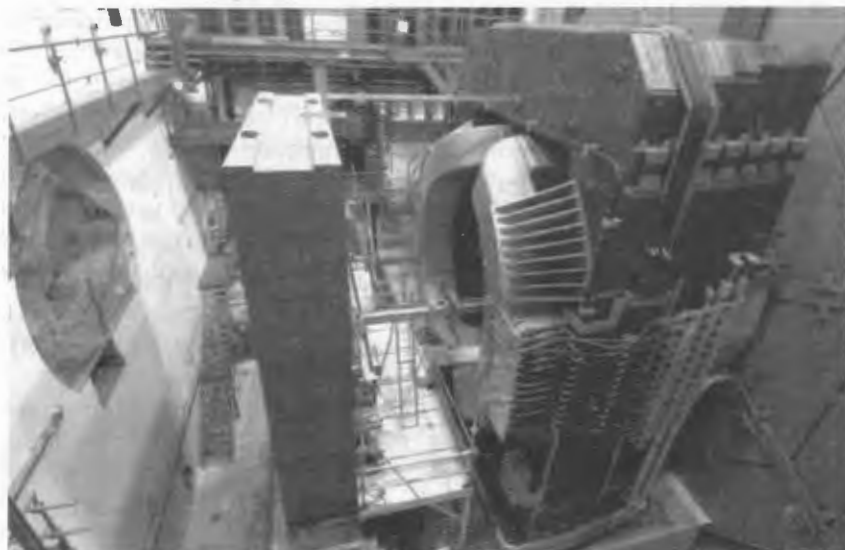
Дипольный магнит собран в рабочей позиции и испытан при полном токе
