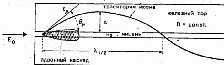
Рис. 3. Принцип работы спектрометра NA-4 \Delta = \frac{M_\mu}{c \cdot 4B} \cdot \frac{Q^2}{Q_{\text{max}}^2} \cdot \lambda_{1,2} = 0,66 \cdot P_L / B .
