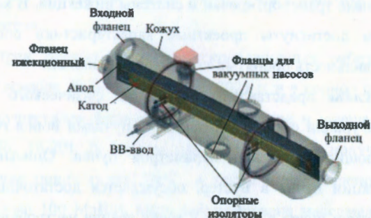
Рис. 5. Конструкция электростатического септума [4].
