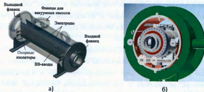
Рис. 6. Конструкция модулей инфлекторных пластин: а) модуль ИП2 [4]; б) криостатный модуль ИП1/ИП3.
