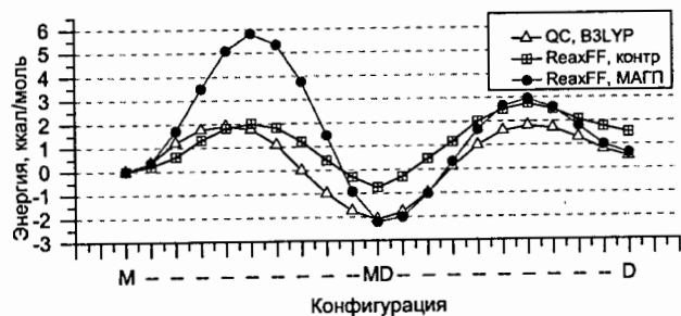
Рис. 5 — Пути диссоциации H 2 O на поверхности ZnO Wurtzite (10 \bar{1} 0). QC, V3LYP — результаты расчётов КХ; ReaxFF, контр — контрольный набор; ReaxFF, МАГП — результаты, полученные автором
