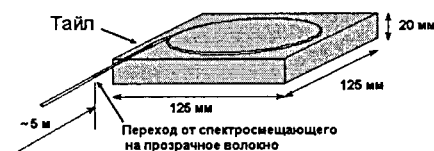
Рис. 14. Сцинтилляционная пластина (тайл). модуля CPR2 в США.
