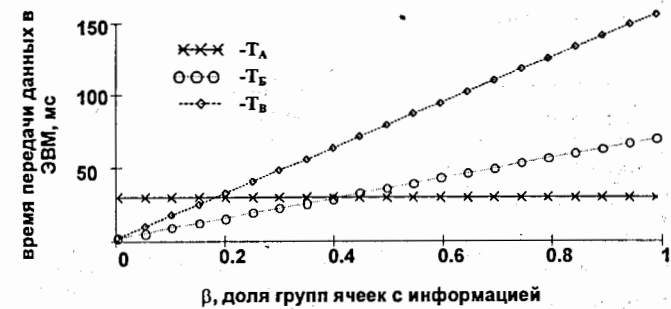
Рис. 13. Графическое представление времени передачи годоскопических данных в ЭВМ в зависимости от параметра \beta для режимов: T_B и T_B . Время T_A не зависит от \beta и приведено для сравнения.
