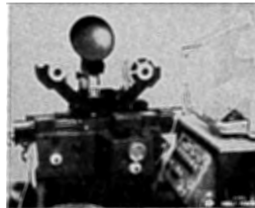
Рис.3. Измерительный терминал, состоящий из микроскопа типа Цейсс с электроникой, телекса и клавишного пульта.
