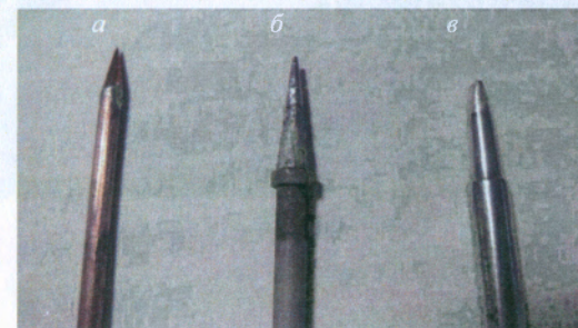
Рис. 4. Виды наконечников для паяльника: а) медный голый наконечник (заточен в виде конуса); б) никелированный медный наконечник в виде конуса; в) никелированный наконечник в виде шлицевой отвертки
