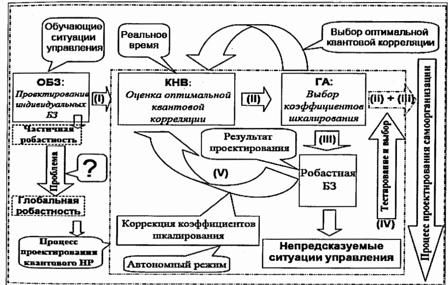
Рис. 1.2. Проектирование робастных БЗ в условиях непредвиденных ситуаций управления: структура технологии и этапы проектирования
