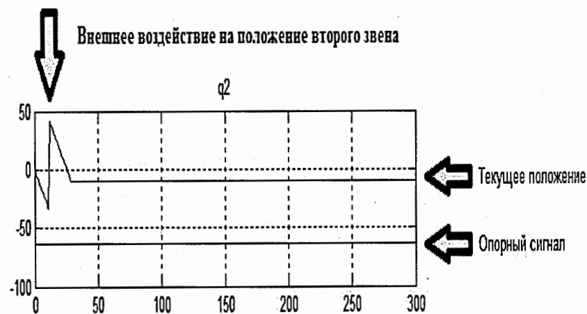
Рис. 3.11. Моделирование внешнего воздействия на второе звено манипулятора
