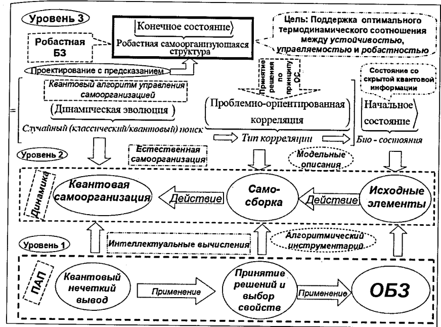
Рис.1.14. Иерархическая структура КА проектирования самоорганизации робастных БЗ в ИСУ (ПАП – программно-аппаратная поддержка)
