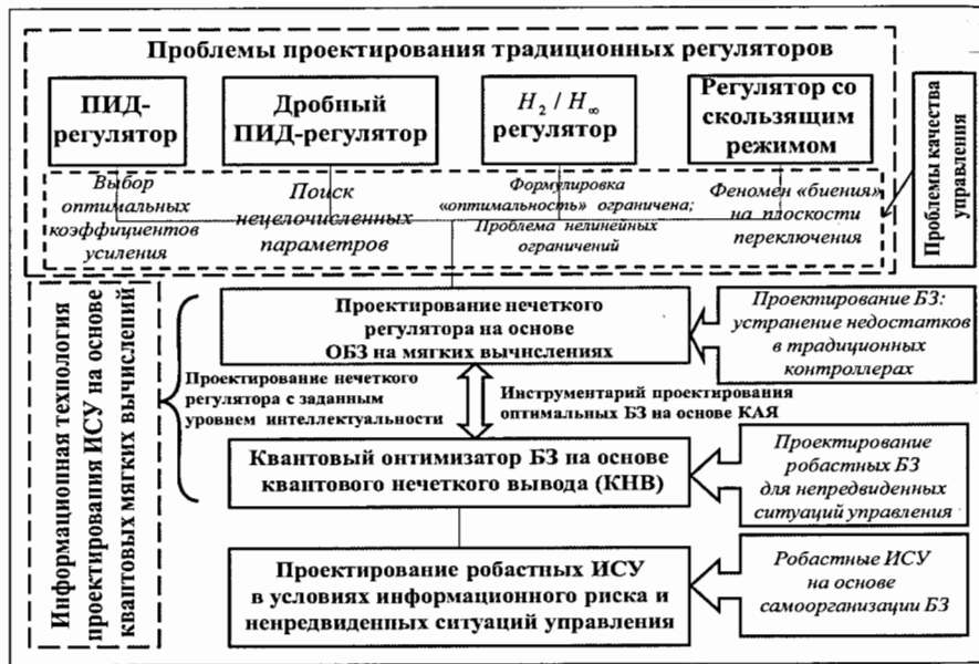
Рис. 1.22. Структура реализации информационной технологии проектирования робастных интеллектуальных регуляторов
