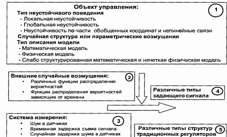
Рис. П.1. Структура САУ (а) и типовые источники непредвиденных ситуаций управления (б)
