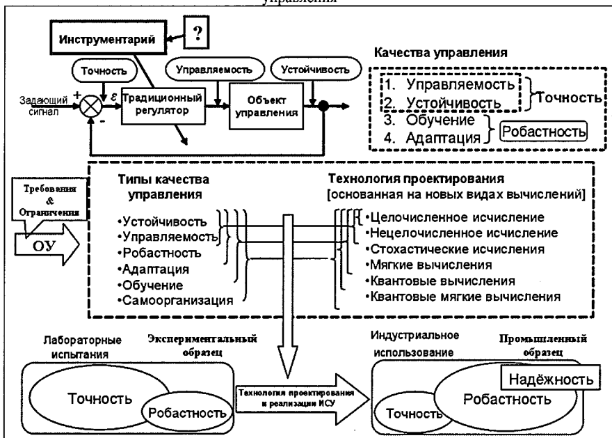
Рис. 2.5. Взаимоотношение между критериями качества управления, видами интеллектуальных вычислений и моделирования в технологии проектирования робастных БЗ НР
