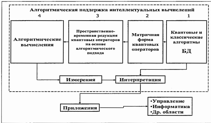
Рис. 1.25. Структура алгоритмической поддержки интеллектуальных вычислений
