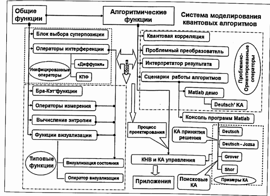
Рис. 1.27. Структура блока «Quantum computational intelligence» на рис. 1.26
