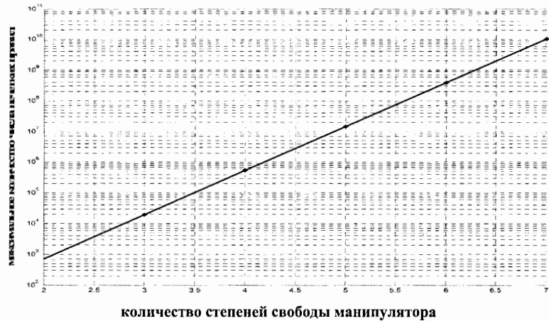
Рис. 5.12. Зависимость максимального числа нечетких правил от числа степеней свободы манипулятора
