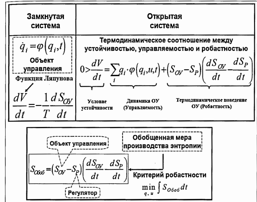
Рис. 2.2. Термодинамический критерий качества робастного управления
