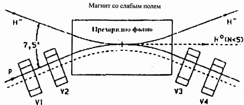
Рис. 7.3. Схема перезарядной инжекции
