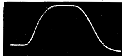
Рис. 2.2. Осциллограмма напряжения ИТ-800. Длительность импульса 400 мкс
