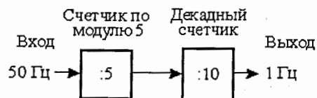
Рис.10.11. Структурная схема делителя частоты на 50
