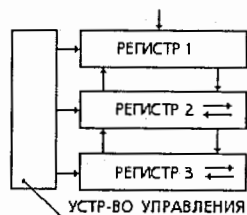
Рис.13.4. Схематическое АЛУ с непосредственной связью
