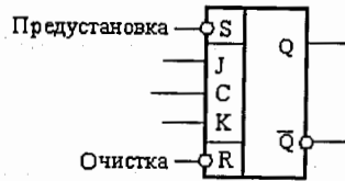
Рис.9.23. Условное графическое обозначение JK-триггера
