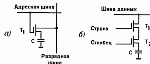
Рис.12.10. Запоминающая ячейка динамического ОЗУ
