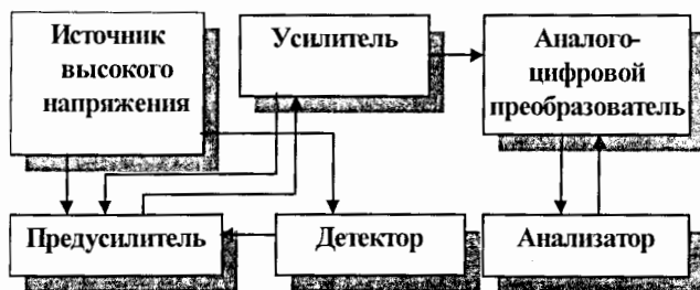
Рис. 2.8. Блок-схема гамма-спектрометрической системы
