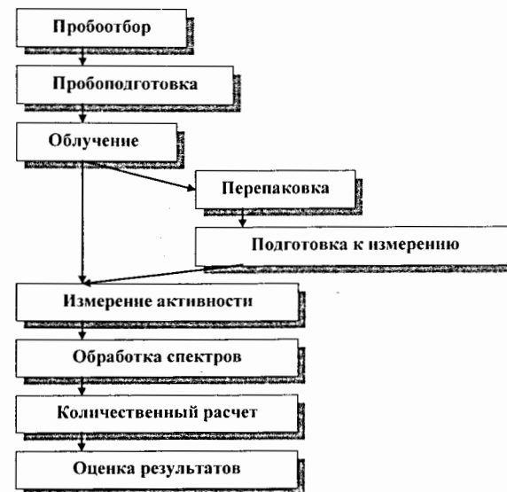
Рис. 2.1. Схема проведения НАА
