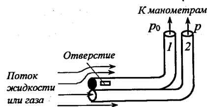
Рис. 9.7. Схема трубки Пито-Прандтля
