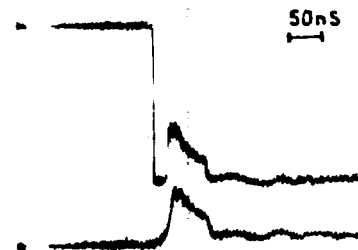
Рис.4. Осциллограммы выходных сигналов датчика и высокоомного делителя.
