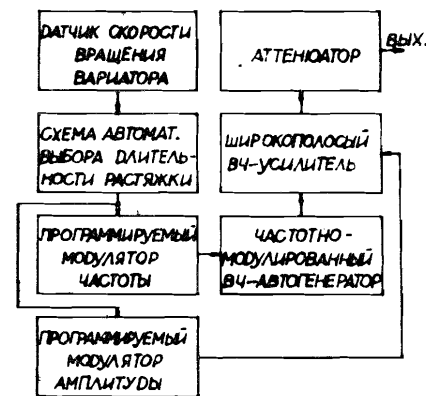
Рис. 6. Блок-схема задающего генератора частоты.
