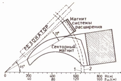
Рис.2. Схема размещения элементов магнитной системы: 1, 2 - границы зоны формирования требуемых изменений магнитного поля.
