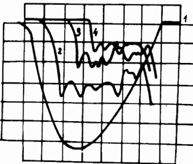
Рис.10. Загрузка кольца ионами свинца. 2, 3, 4 - сигналы ФЭУ 9 /см. рис.2/ тормозного излучения электронов на ионах при t_1 = 400 мкс, t_2 = 200 мкс; t_3 = 0 мкс от максимума тока /1/ IV ступени соответственно.
